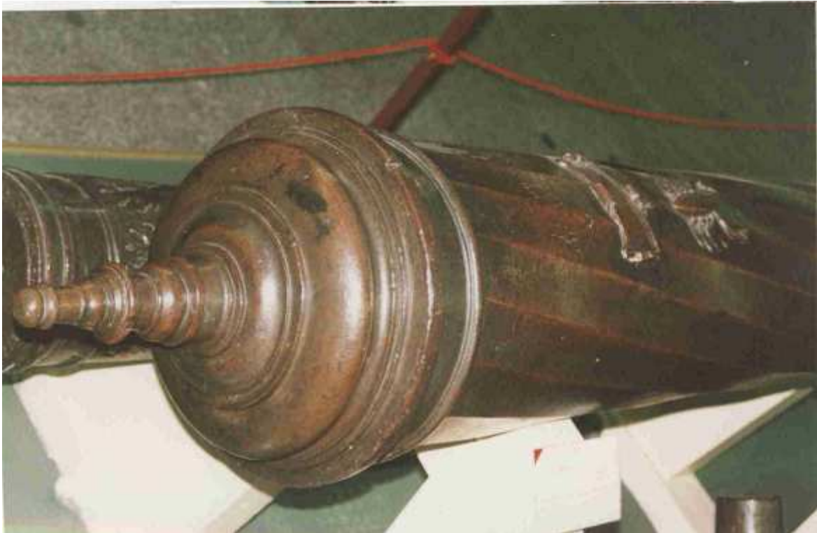
Medio cañón aculebrinado y reforzado, de 14 cm por 334 de longitud de ánima, o sea, cerca de 24 calibres, de fundición inglesa. Es de bronce fundido en hueco con diestras
