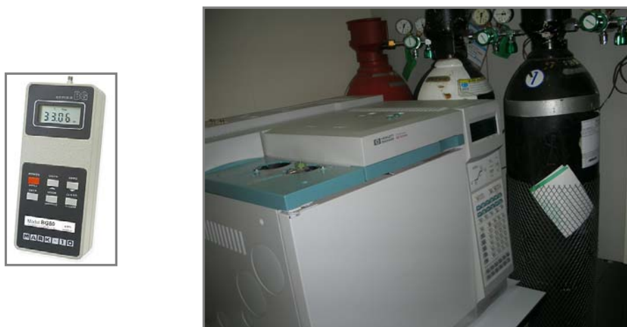
Fig. 2.12. Penetrómetro usado para determinar la firmeza del fruto (a la izquierda) y cromatógrafo de gases (a la derecha) usado para la producción de etileno y cuantificación de ACC/MACC.
