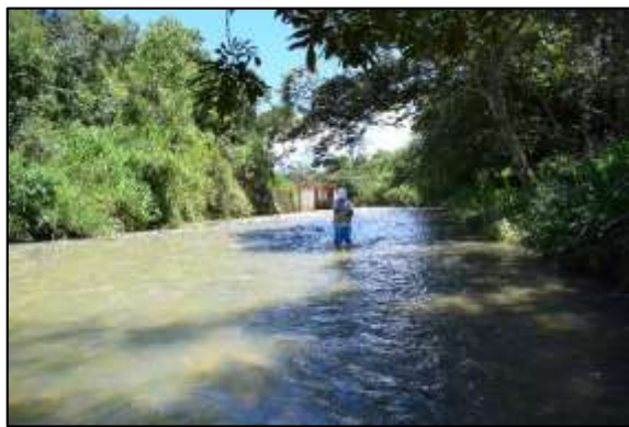
Medición de caudal, por método de área/velocidad
