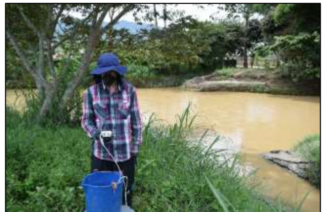
Medición de pH y Temperatura de la muestra, por método electrométrico
