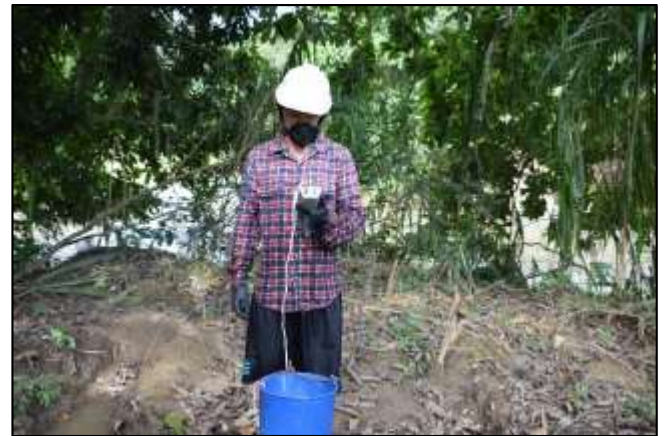
Medición de pH y Temperatura, por método electrométrico
