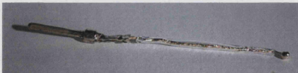
Figura 4.5: Imagen de uno de los electrodos de oro preparados para el crecimiento de una monocapa.
