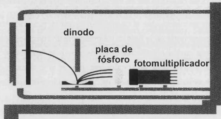
Figura B.6: Esquema de un detector fotomultiplicador dinolito.
