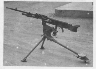
FRENCH 8-MM HOTCHKISS HEAVY MACHINE GUN, M14.
