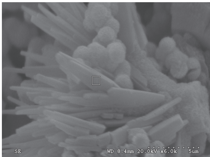
Foto 9. Foto de microscopía electrónica de aragonito en una muestra metalizada con oro obtenida con electrones secundarios.
