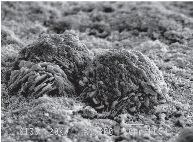
Foto 13. Aspecto de la pátina de una vigueta de hormigón de CAC a 1200 aumentos.
