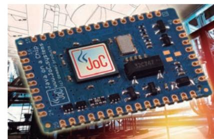
En muchos casos, JoC puede reemplazar la electrónica del microcontrolador convencional y, por lo tanto, simplificar considerablemente el diseño. Las aplicaciones típicas son controladores de todo tipo o evaluaciones de sensores, en las que todas las interfaces de comunicación pueden abordarse fácilmente en Java.
