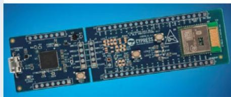
El kit de prototipos Cypress PSoC 6 BLE incluye un módulo CYBLE-416045-02 EZ-BLE™ Creator totalmente certificado basado en un microcontrolador PSoC 63 de bajo consumo y alto rendimiento. El módulo CYBLE-416045-02 presenta 1 Mbyte de flash de la aplicación, junto con un área EEPROM de 32 Kbytes y 32 Kbytes de flash seguro más una pila Bluetooth LE sin derechos de autor compatible con Bluetooth 5.0.
