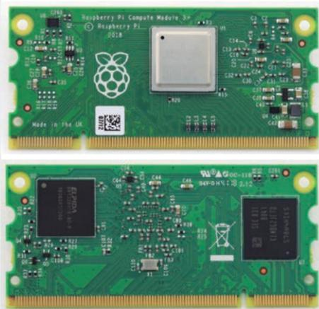
El Raspberry Pi Compute Module 3+ se basa en el procesador de aplicación Broadcom BCM2837B0 de 64 bits que funciona a 1,2 GHz con SDRAM LPDDR2 de 1 GB. Los diseñadores ahora pueden elegir entre las variantes de Flash eMMC de 8 GB, 16 GB y 32 GB y la variante 'Lite' sin Flash eMMC, para responder a sus requisitos de almacenamiento.
