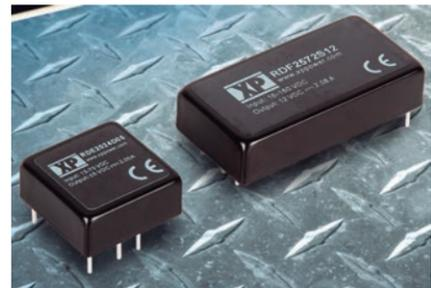
permiten que se puedan utilizar en una gran variedad de aplicaciones. Las series de 20W RDE20, presentan un rango de entrada 4:1, cubriendo las tensiones nominales de 24, 37.5 y 48VDC en las versiones con una entrada de 13 a 70VDC, y las tensiones nominales de 72 y 110VDC con las versiones con una entrada de 42 a 176VDC. Las series de 25W RDF25 cuentan con un ultra rango de entrada 10:1 de 16-160VDC cubriendo todas las tensiones nominales de entrada de 24VDC a 110VDC con un solo dispositivo.
