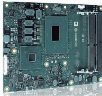
El COMe-bCL6 se basa en la familia de procesadores Intel® Core (TM) o Intel® Xeon® E de octava generación con chipset móvil (CM246 / QM370 PCH), que garantiza la más alta calidad industrial y posibilidades de aplicación flexibles. El módulo COM Express® está disponible en varias versiones de procesador, incluidos los modelos de procesador de seis núcleos.
