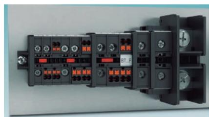
Con los puentes enchufables de dos polos del sistema de bornes para carril con ahorro de espacio Clipline complete se conectan a voluntad muchos bornes en un bloque de distribución de potencial. Todas las carcasas del borne se han diseñado con protección contra contacto de los dedos. De este modo, no se precisa ninguna protección de regleta de bornes adicional.
