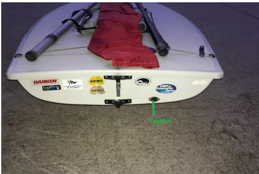
Por lo general los casco de los veleros monotipos o dinghy, tienen zonas estancas que llevan un tapón de seguridad. Existen otros tipos de cascos que además tienen y un sistema de desagüe de la bañera o cockpit llamado Bailer.
