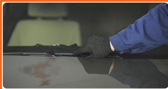
Aparte la palanca de limpiaparabrisas fuera de la superficie de cristal hasta el fin.
