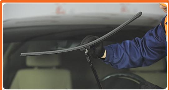
Inserte la escobilla nueva de limpiaparabrisas así que su enclavadura entre en la atadura en la palanca.
