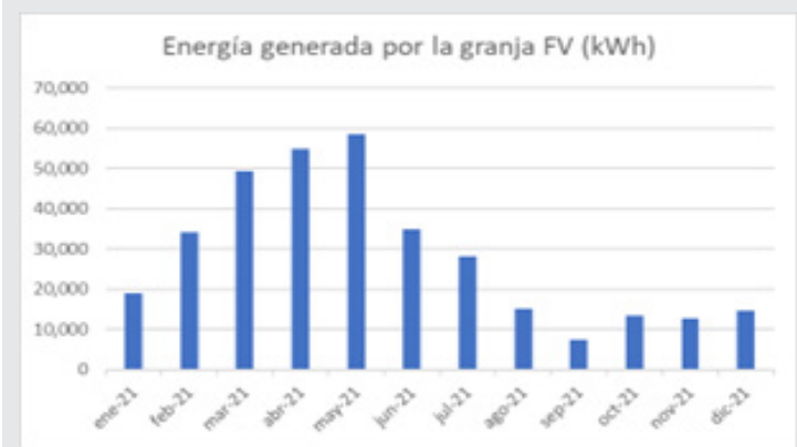
Figura 1. Energía generada por la planta fotovoltaica en el año 2021
