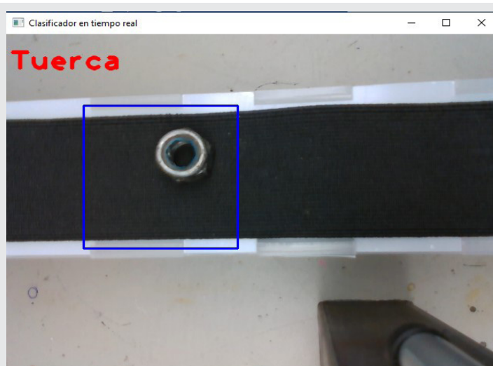
Figura 11. Detección de una tuerca sobre la banda transportadora. Fuente: Elaboración propia.
