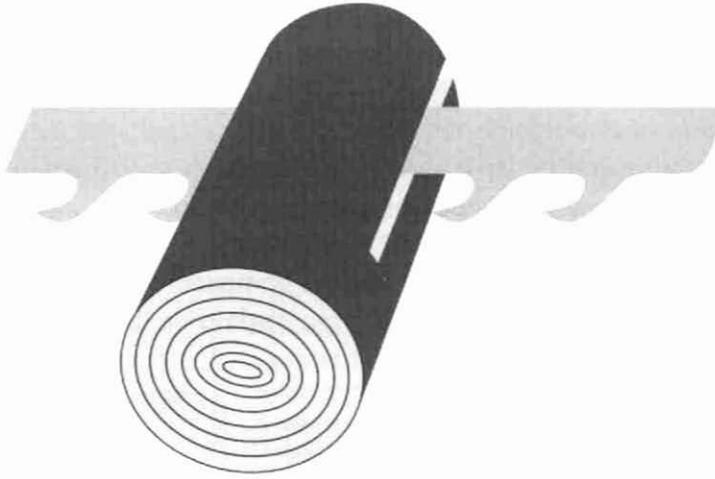
**B. *Debobinado:*** mediante este procesamiento los troncos se hacen rotar sobre su eje comprimiéndolo contra un cuchillo que, sin producción de aserrín, produce una hoja de un ancho equivalente al largo del trozo, cuya longitud depende del diámetro del tronco. Las delgadas hojas de madera que se obtienen (chapas debobinadas) con un espesor de 1 a 3 mm, se usan para la producción de paneles compensados, fósforos, baja lenguas, etc.
