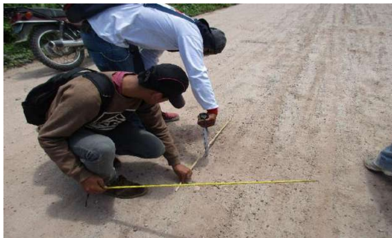
Medición de una deformación en vía San Marcos– N. Horizonte – Alto Perú
