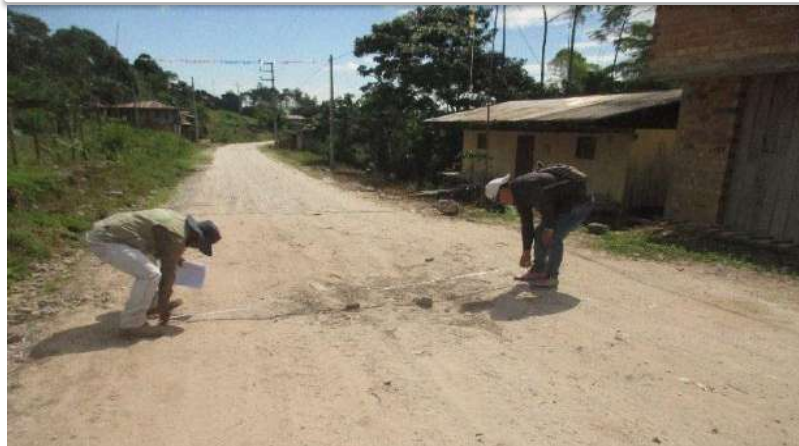
Medición de una deformación en vía San Marcos– N. Horizonte – Alto Perú
