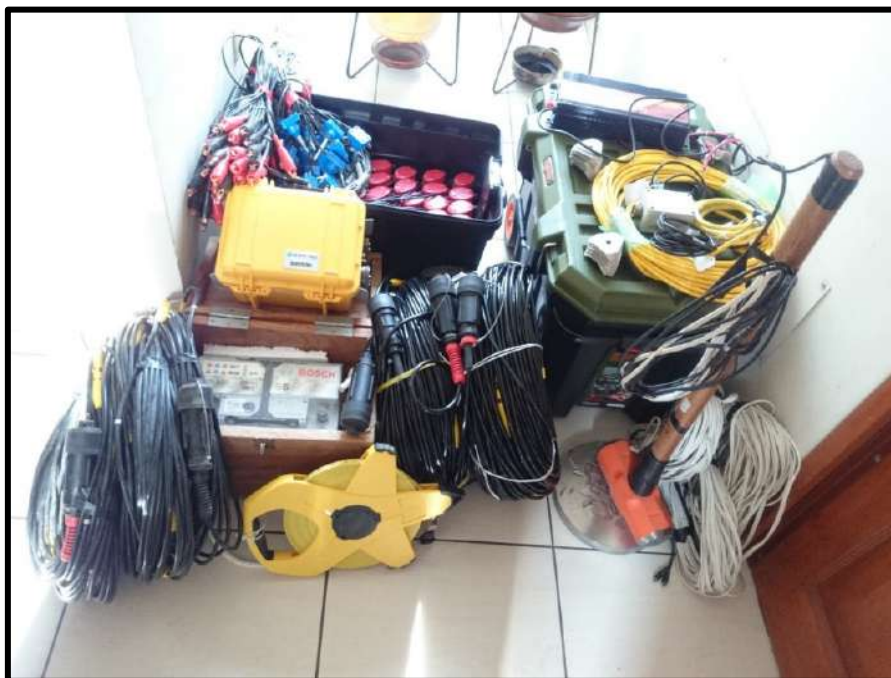
Figura 23: Fotografía de las partes de un equipo de refracción sísmica.
