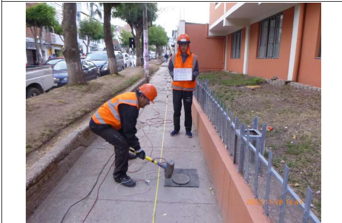
FOTO 02: Personal geofísico ejecutando el SHOT 02 del ensayo MASW-01.
