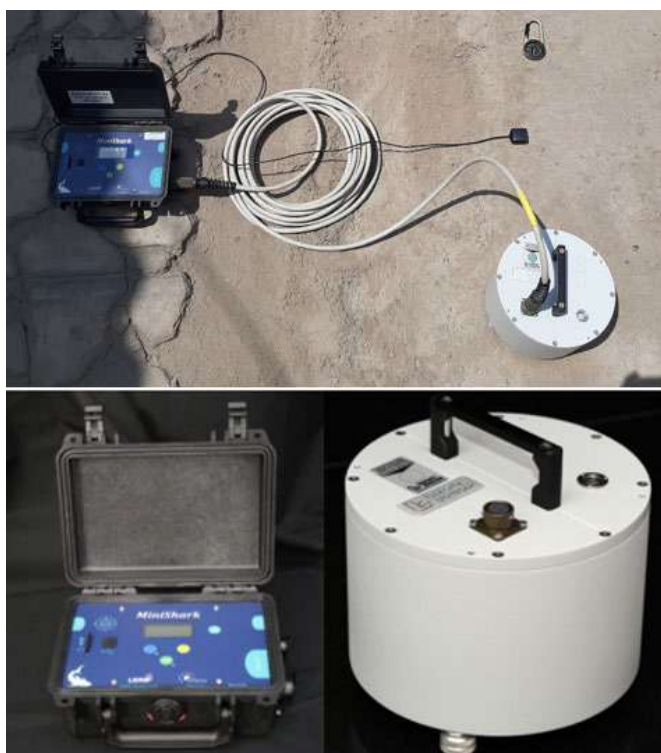
Figura 24: Sismógrafo y adquisidor.
