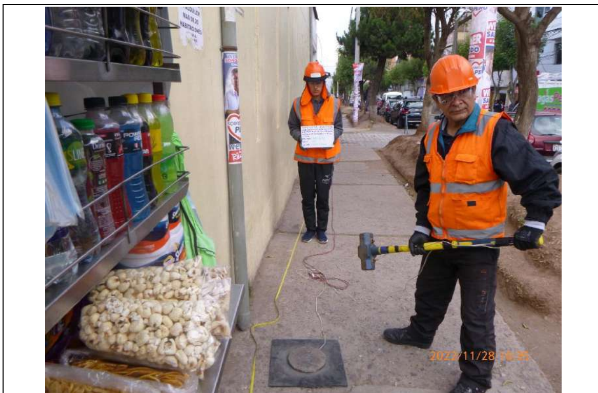
FOTO 01: Personal geofísico listo para ejecutar SHOT 02 del ensayo MASW-01.
