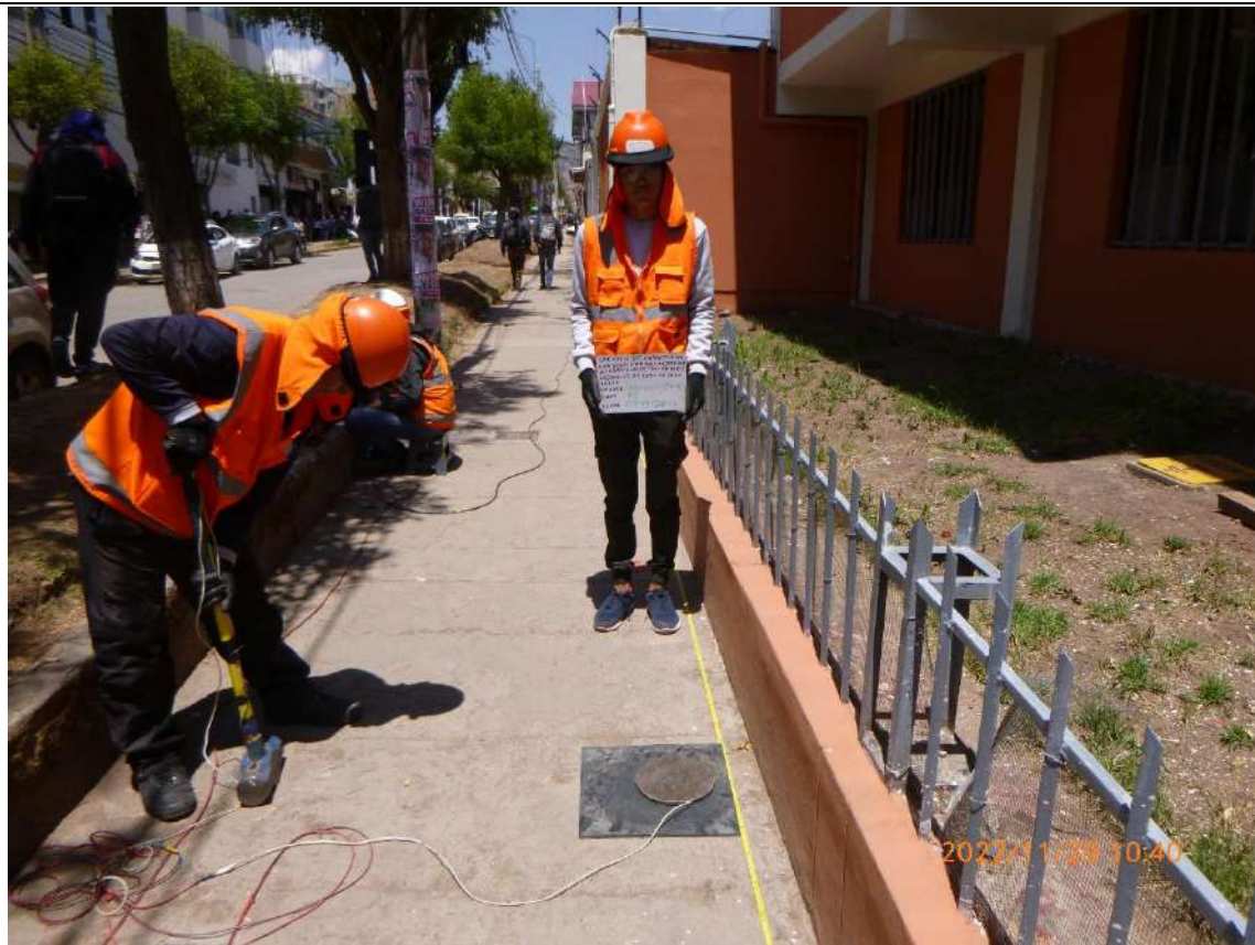
FOTO 01: Personal listo para ejecutar el SHOT 01 para el ensayo MASW 2D -01. ZONA: Sencico – Sede Cusco.
