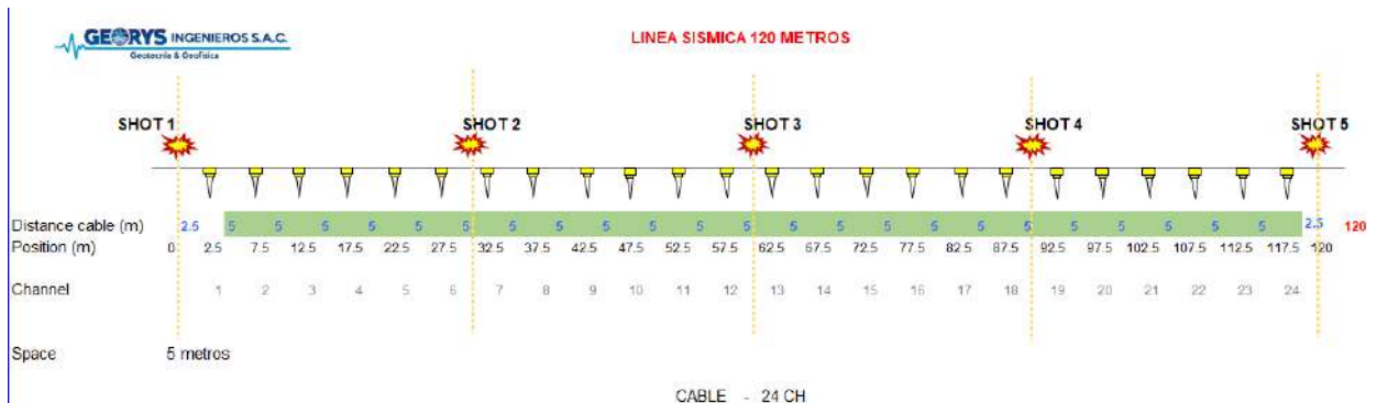
Figura 02: Esquema: Tendido Sísmico Característico y Disposición de los Puntos de impacto “Shot Points”
