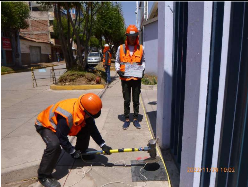
FOTO 01: Personal listo para ejecutar el SHOT 01 para el ensayo MASW 2D -01. ZONA: Sencico – Sede Cusco.
