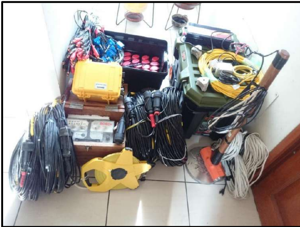
Figura 23: Fotografía de las partes de un equipo de refracción sísmica de Georys Ingenieros S.A.C.
