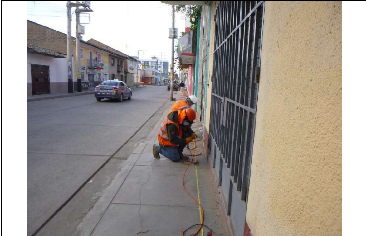
FOTO 03: Distribución de los geófonos y cable sísmico para el ensayo MASW-02.
