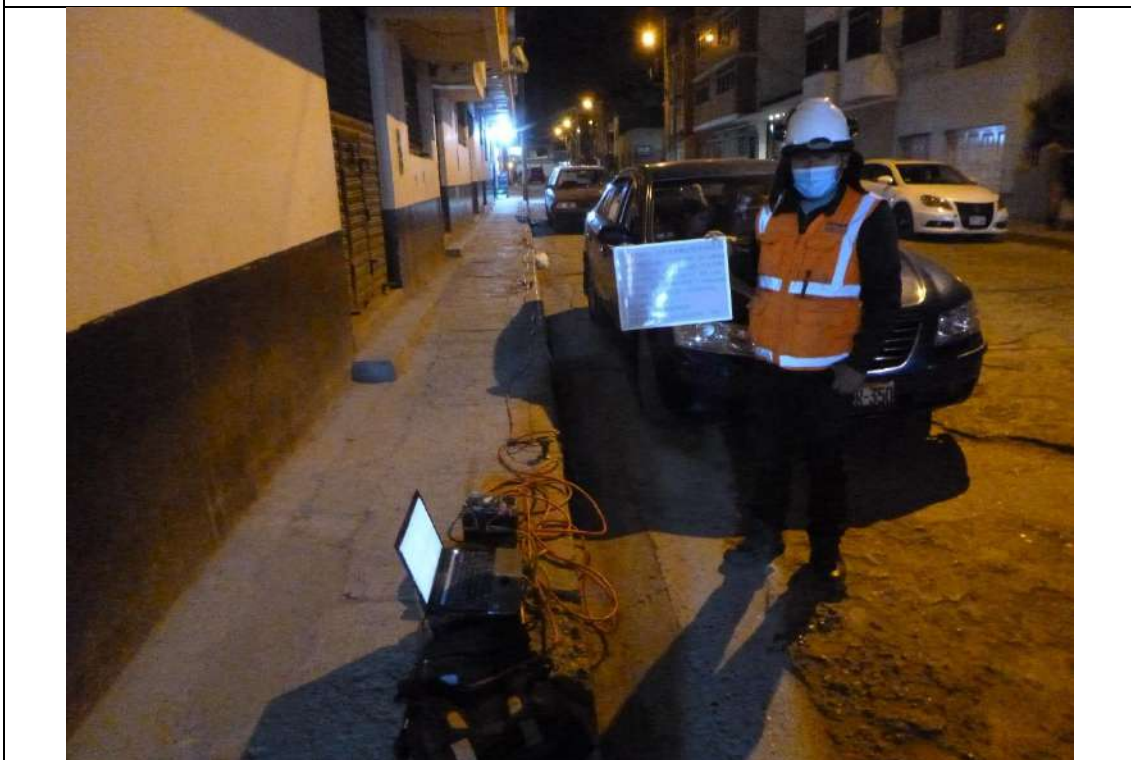
FOTO 02: Operador geofísico adquiriendo data para el ensayo MAM-01.
