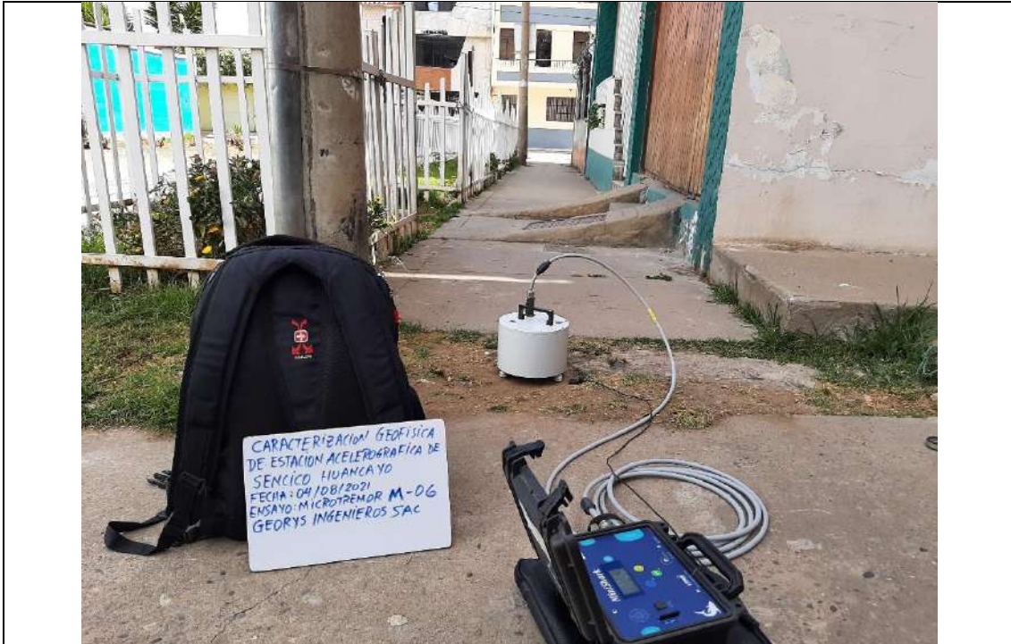
FOTO 01: Momento de la adquisición de datos correspondiente al ensayo MIC-01. ZONA: El Tambo – Huancayo.
