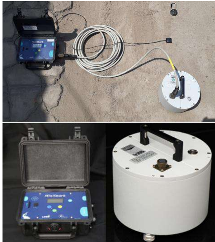
Figura 24: Sismógrafo y adquisidor de propiedad de Georys Ingenieros S.A.C
