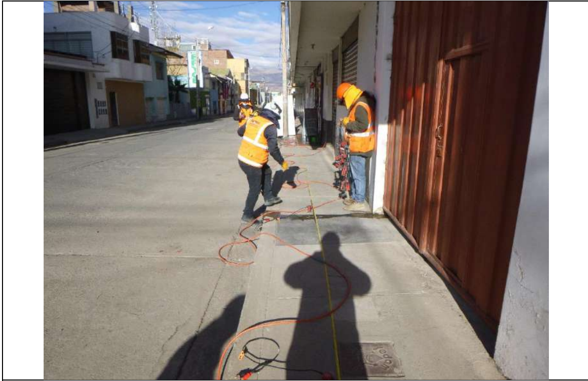
FOTO 01: Distribución de los geófonos y tendido del cable sísmico en la línea LS-01. ZONA: El Tambo – Huancayo.
