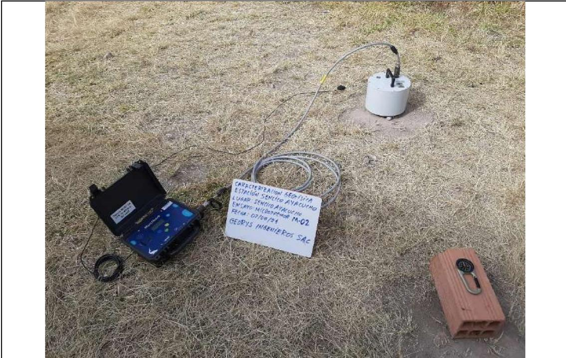
**FOTO 03:** Adquisición de datos para el ensayo MIC-02.
