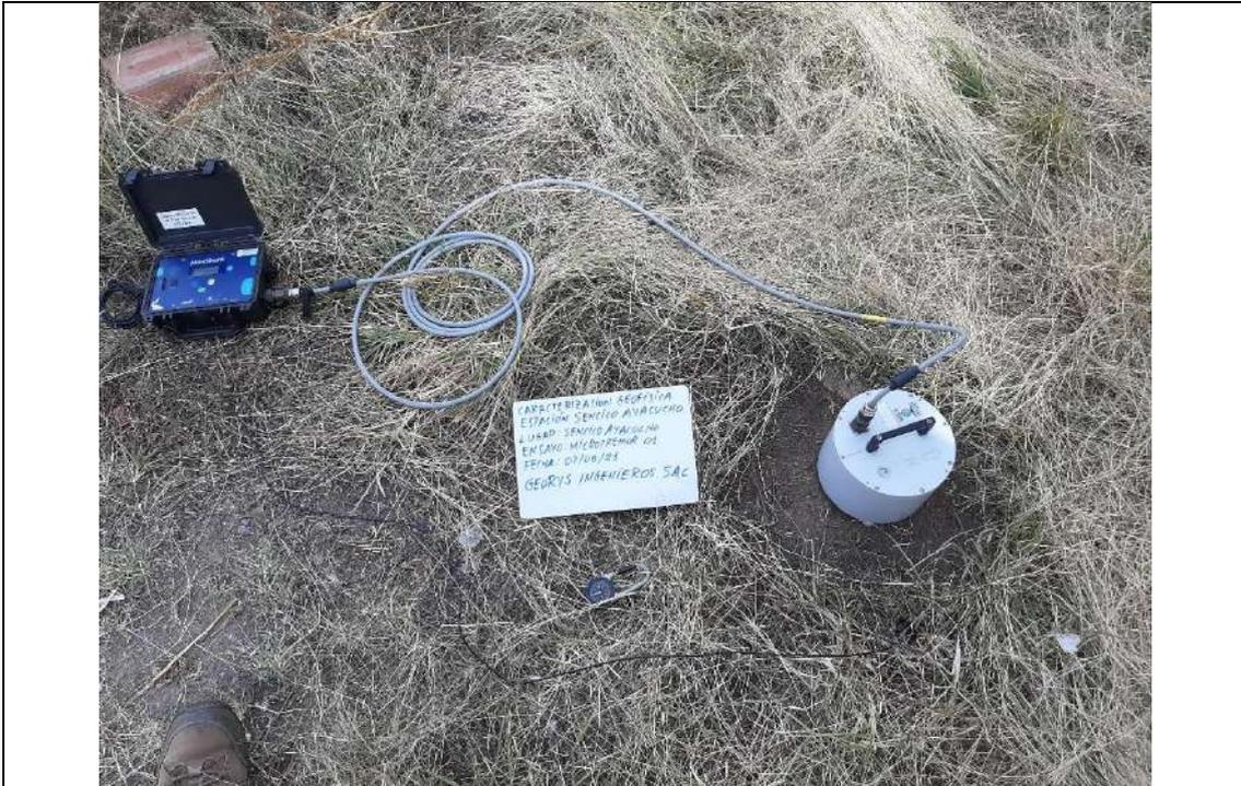
**FOTO 01:** Momento de la adquisición de datos correspondiente al ensayo MIC-01.
