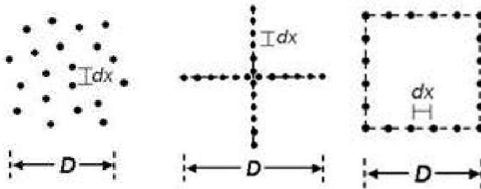
**Figura 15:** Configuraciones en forma de aleatoria de un arreglo MAM con 20 geófonos, de un arreglo en cruz de 24 geófonos y de un arreglo cuadrado de 20 geófonos.
