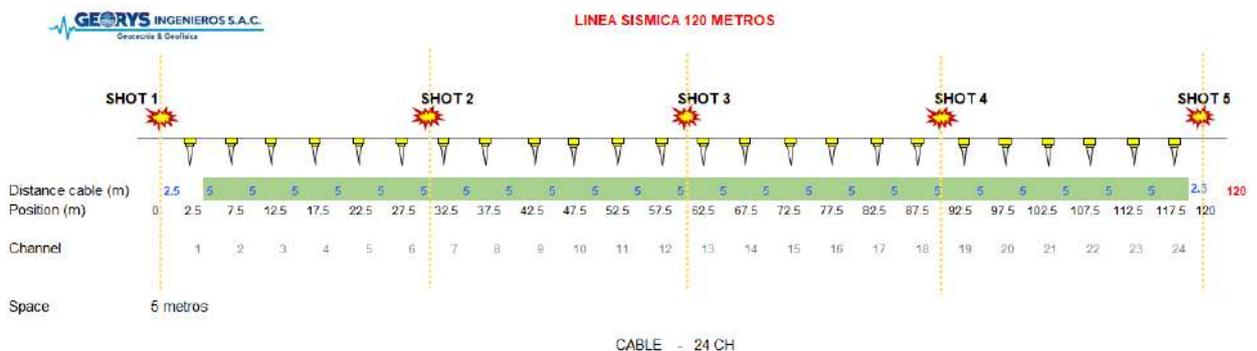
**Figura 02:** Esquema: Tendido Sísmico Característico y Disposición de los Puntos de impacto “Shot Points”
