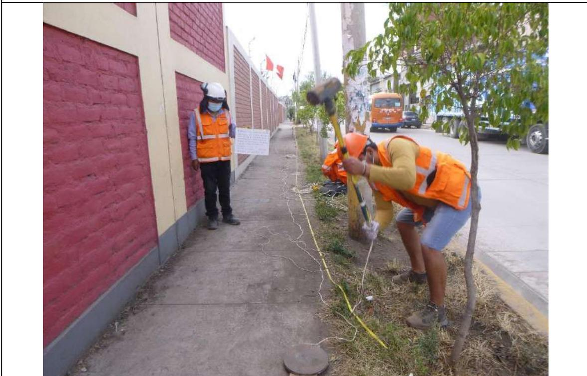
**FOTO 02:** Personal geofísico ejecutando SHOT 01 del ensayo MASW-01.
