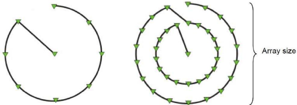
**Figura 14:** Configuraciones en forma de circular de un arreglo MAM con 9 y 37 geófonos.
