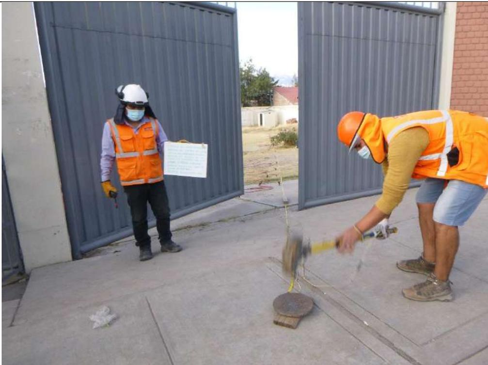
**FOTO 04:** Personal geofísico ejecutando SHOT 01 del ensayo MASW-02
