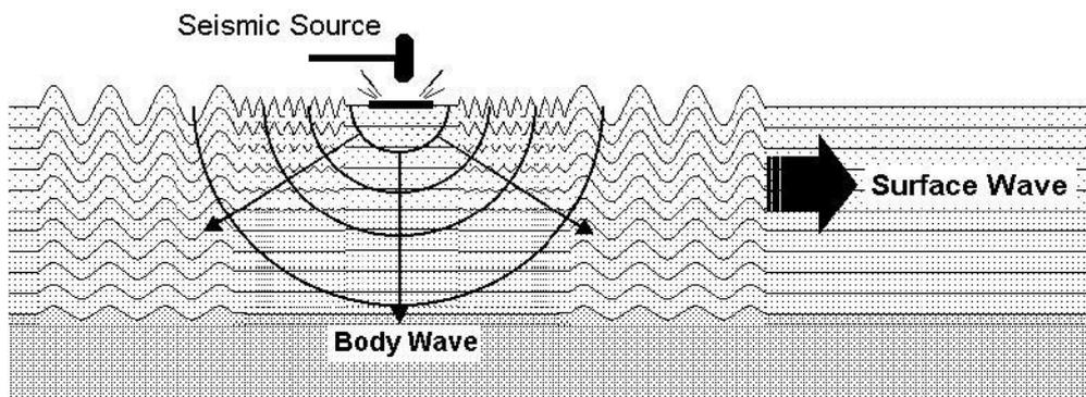
**Figura 05:** Dos grandes grupos de ondas sísmicas: ondas de cuerpo y superficiales. Las ondas corporales se propagan a través del cuerpo, mientras que las ondas superficiales viajan a lo largo de la superficie del medio.
