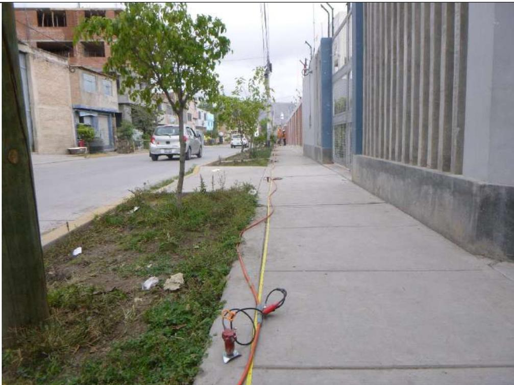
**FOTO 02:** Distribución de los sensores y el cable de refracción para el ensayo MAM-01.
