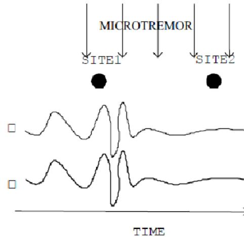
**Figura 18:** La microtrepidación se propaga verticalmente. a la línea de los geófonos, la velocidad de fase no se puede calcular
