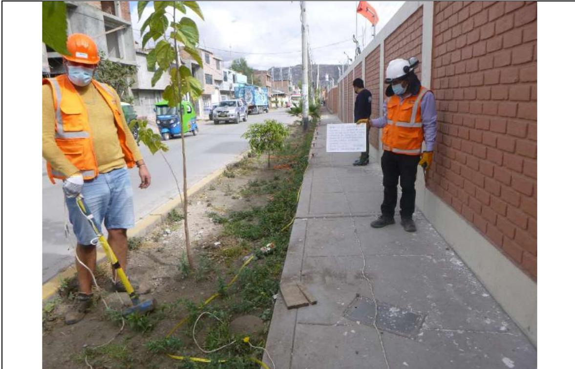
**FOTO 01:** Personal geofísico listo para ejecutar SHOT 01 del ensayo MASW-01.
