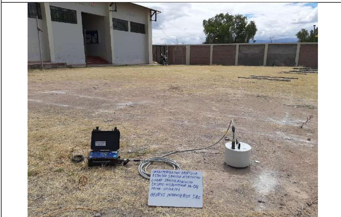
**FOTO 06:** Vista del equipo para realizar el ensayo de microtremor MIC-03.
