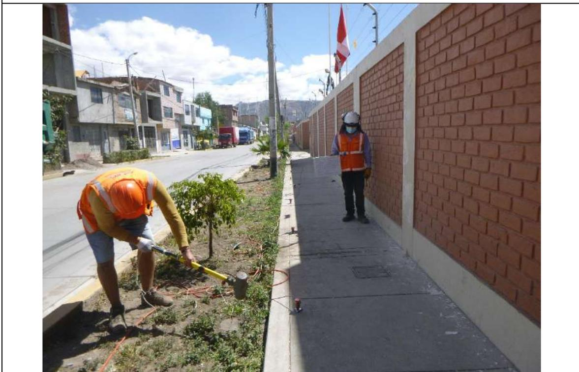
**FOTO 02:** Personal ejecutando SHOT para el ensayo MASW 2D-01.
