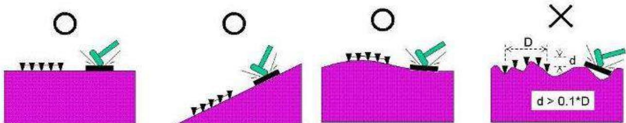
**Figura 08.** Condiciones de terreno típicas favorables y desfavorables para el ensayo MASW
