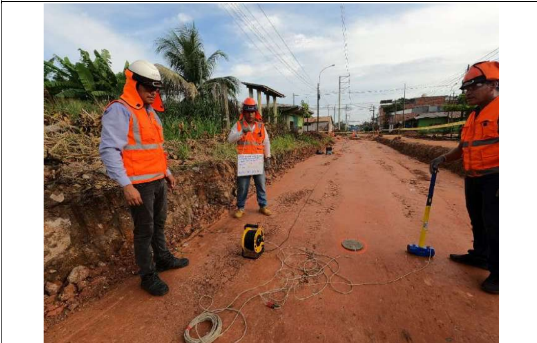
FOTO 04: Personal geofísico listo para ejecutar el SHOT 01 del ensayo MASW-02
