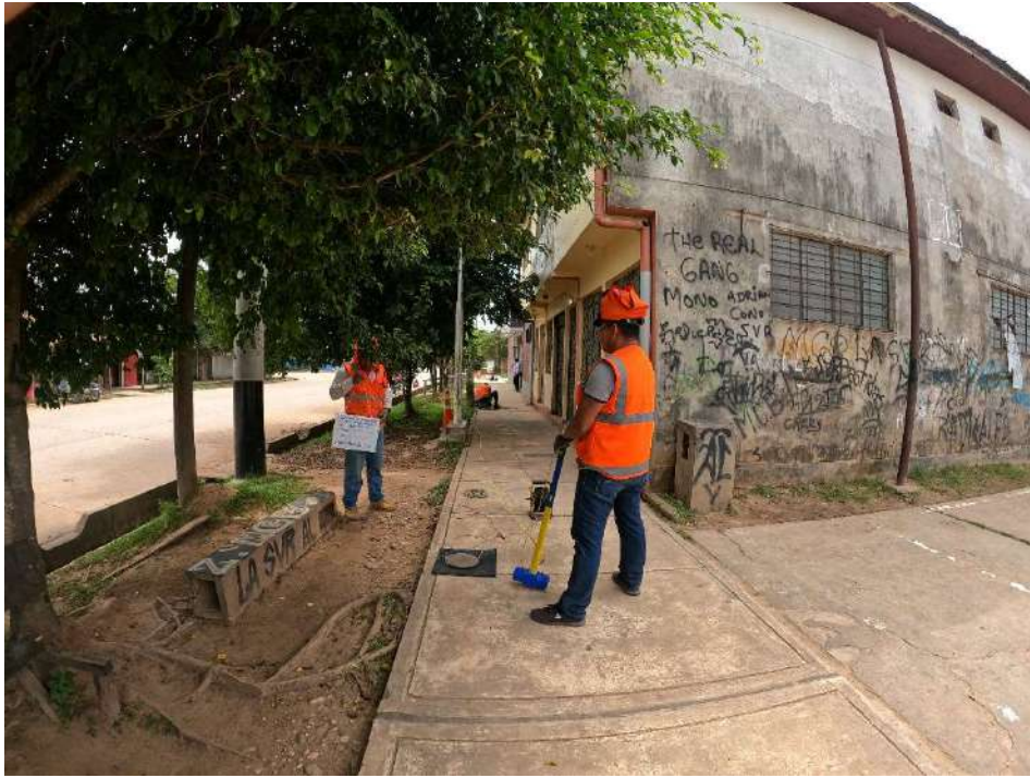
FOTO 01: Personal geofísico listo para ejecutar SHOT 01 del ensayo MASW-01. ZONA: Sencico – Sede Pucallpa.
