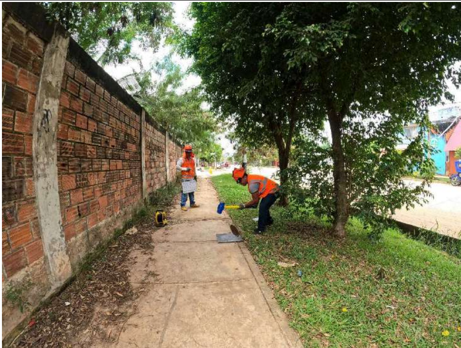
FOTO 02: Personal geofísico ejecutando el SHOT del ensayo MASW-01. ZONA: Sencico – Sede Pucallpa.
