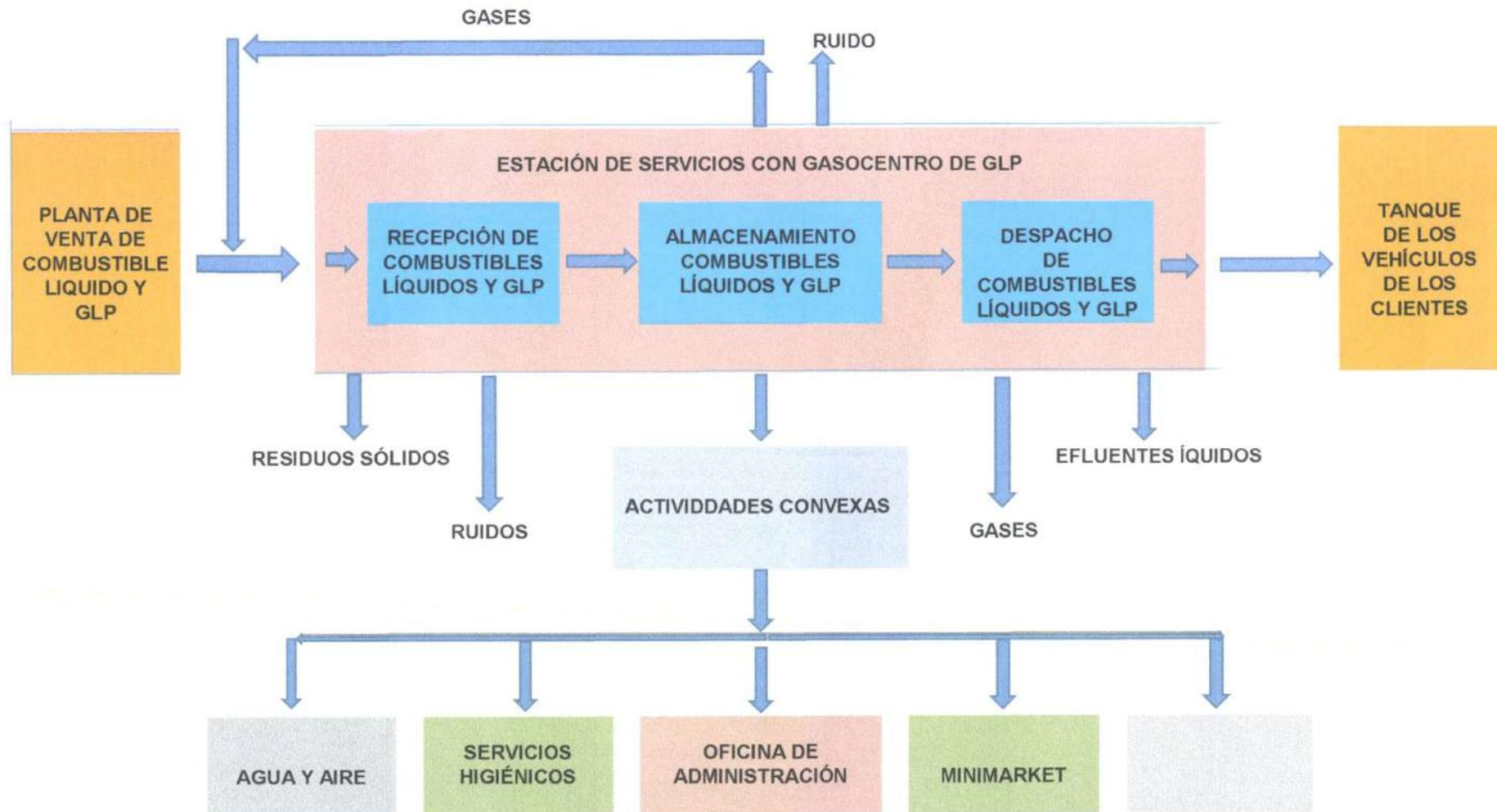
FIG. N° 3-5 DIAGRAMA DE FLUJO DE LAS ACTIVIDADES DE LA ESTACIÓN DE SERVICIOS CON GASOCENTRO DE GLP
