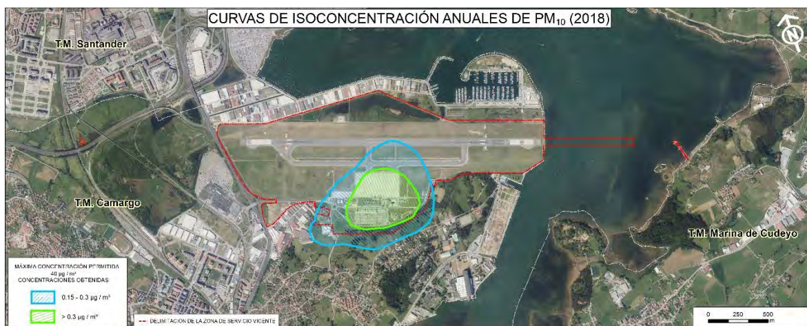
Ilustración 1.7. Curvas de isoconcentración anuales de PM 10 del aeropuerto de Seve Ballesteros-Santander
