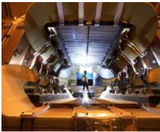
Fig.6. El imán convencional del experimento LHCb, que permite separar materia de anti-materia. Fuente: CERN.
