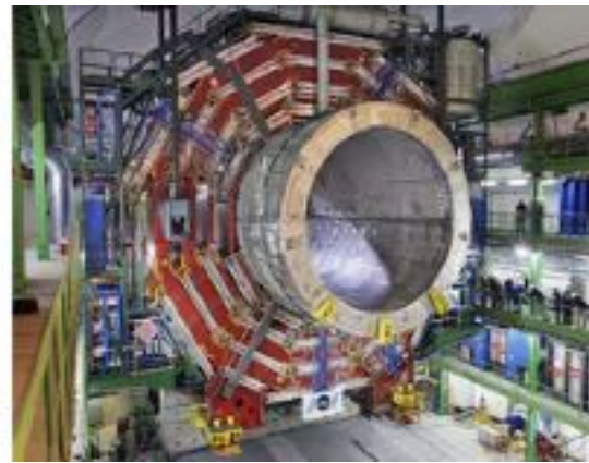
Fig.5 El solenoide del experimento CMS, rodeado de cámaras de muones entre el hierro magnetizado. Fuente: CERN.
