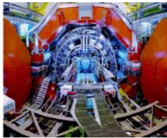
Fig.7. El experimento ALICE estudia las colisiones ión-ión. Los detectores se encuentran dentro de un solenoide horizontal. Fuente: CERN.
