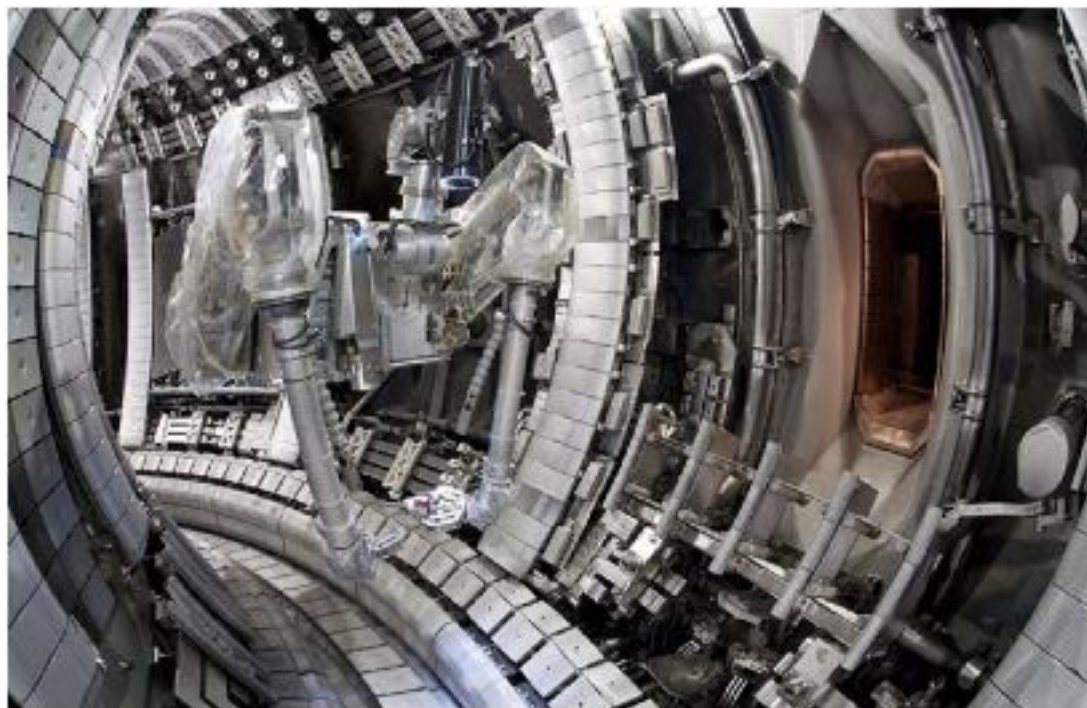
Fig.10. Vista interior del Tokamak europeo JET, donde se está mejorado la pared y el desviador para asemejarlos a ITER. (Foto © iter.org)
