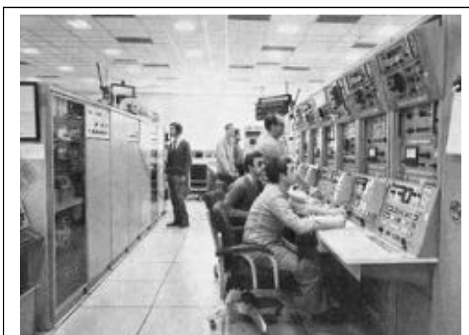
Fig.14. Fresnedillas. En primer plano consola de Receptores en la sección de Radiofrecuencia, y al fondo la consola del Servo (Antena). Todo el equipo en funciones es español. (1971)
