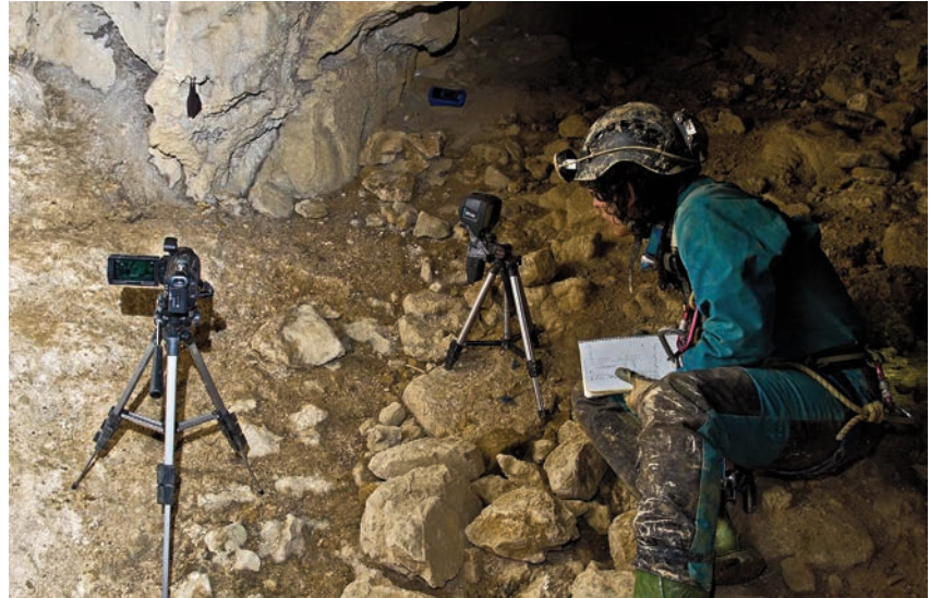
IMAGEN 5. Toma de datos durante un episodio de estímulo "fotografía". En la imagen se observan la cámara de vídeo y cámaras termográficas colocadas sobre trípodes, y el sensor registrando temperatura y humedad relativa. Foto: I. Latasa (GAES).
