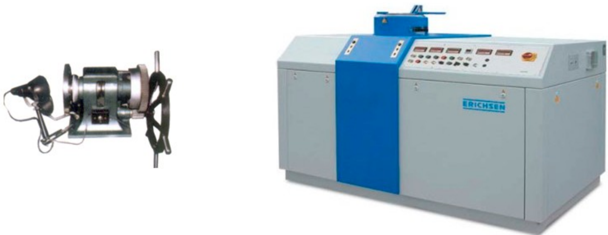
Figura 2.26: Comparación de una máquina específica de ensayos Erichsen manual (izquierda) y un centro universal de ensayo de láminas para investigación (derecha). Fuente: www.erichsen.de
