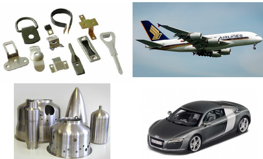
Fig 1.1. Componentes obtenidos por conformado de chapa
