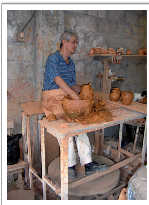
A la izquierda el torno girado por los pies del artesano
