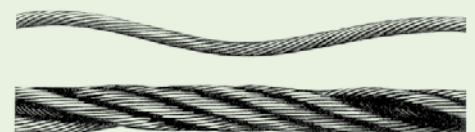
Paso de cableado
