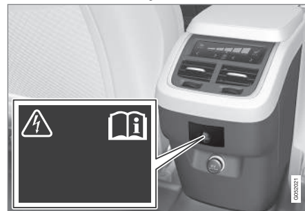
Toma eléctrica en consola del túnel, segunda fila de asientos.
