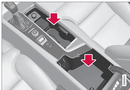
Compartimentos con portavasos, toma eléctrica y entrada USB en la consola del túnel.
