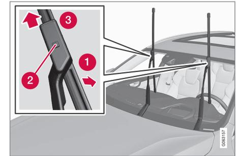
Despliegue el brazo del limpiaparabrisas cuando se halle en posición de servicio. El modo revisión se activa y desactiva a través de la vista de funciones de la pantalla central cuando el automóvil está detenido y los limpiaparabrisas no están funcionando.
