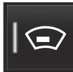
Pulse el botón **Pantalla virtual** de la vista de funciones de la pantalla central. La indicación del interruptor se enciende cuando está activada la función.
