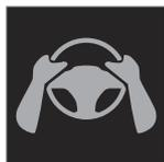
Si Pilot Assist detecta que el conductor no tiene las manos en el volante, tras unos momentos, indicará al conductor que conduzca el automóvil de forma activa mediante un símbolo y un
