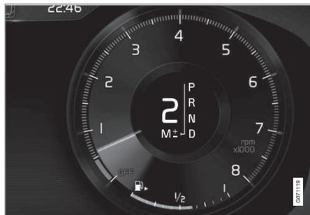
Visión general del patrón de cambios en la pantalla del conductor para la palanca de cambios grande.
