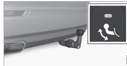
Lleve el enganche para remolque a su posición final donde se fija y se bloquea. La luz de indicación se enciende con luz fija de color naranja.
