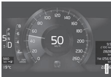
Ejemplo de información del ordenador de a bordo en la pantalla del conductor de 8". La imagen es esquemática. Los detalles pueden variar según el modelo de automóvil.
