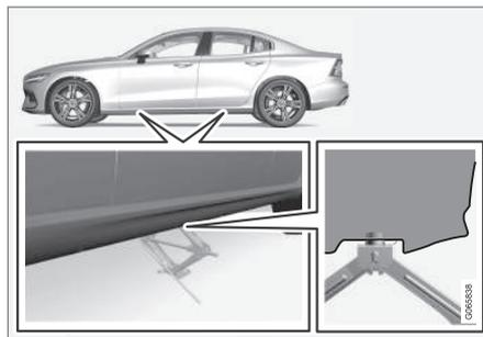
9. Coloque el gato sobre terreno plano y firme que no esté resbaladizo debajo del punto de fijación que se va a utilizar.
