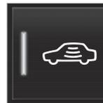
Pulse el botón **Protección reducida** de la vista de funciones de la pantalla central para la desconexión temporal del bloqueo de puertas.
