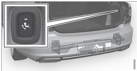
Abra el maletero. El botón para plegar y desplegar el enganche para remolque está situado en el lado derecho de la parte trasera del maletero. La luz de indicación del botón debe encenderse con luz fija de color naranja para que esté activa la función de despliegue.
