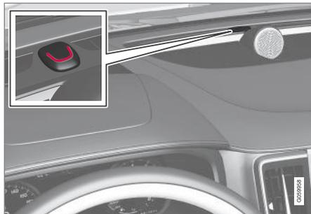
El indicador de bloqueo y alarma muestra el estado del sistema de cierre:
