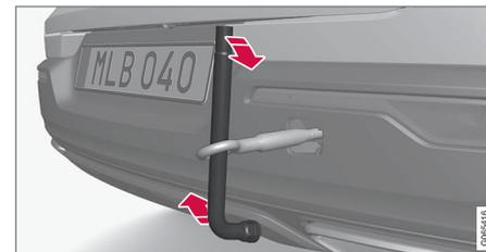
Gire la anilla hasta que quede bien apretada, por ejemplo, atraviésela con la llave para tornillos de rueda\* para hacer palanca.
