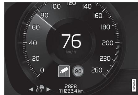
Ejemplo de información sobre cámara de control de velocidad y límite de velocidad en la pantalla del conductor.
