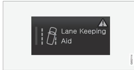
Cuando aparece un triángulo de advertencia a la derecha del botón, algo no funciona debidamente.
