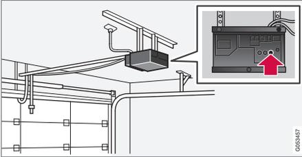
4. Busque el botón de aprendizaje<sup>22</sup> en el receptor de, por ejemplo, la puerta del garaje. Suele estar situado cerca de la sujeción de la antena en el receptor.
