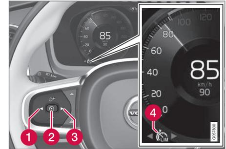
El limitador de velocidad no podrá activarse hasta el arranque del motor. La velocidad máxima más baja que puede guardarse es de 30 km/h (20 mph).
