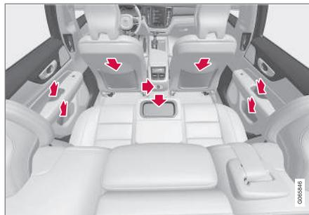
Compartimento en el panel de puerta, portavasos\* en el respaldo de la plaza central, bolsillo\* en el respaldo del asiento delantero y toma eléctrica en la consola del túnel.
