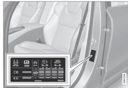
La placa indica la designación de los neumáticos montados de fábrica en el vehículo, así como los límites de carga y la presión de inflado.
