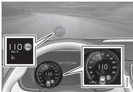
La imagen anterior muestra que se ha ajustado el control de velocidad constante adaptativo para mantener una velocidad de 110 km/h (68 mph) y que no hay ningún vehículo delantero que seguir.
