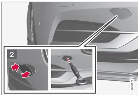
**2** Delante: Retire la tapa de protección - presione sobre la marca con un dedo.
