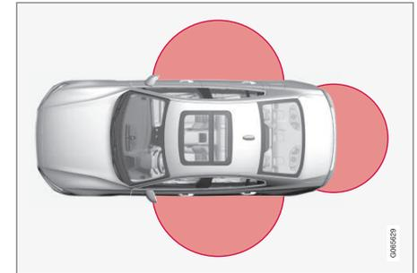
La superficie identificada de la imagen representa las zonas cubiertas por las antenas del sistema.
