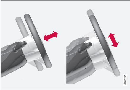
El volante puede ajustarse en profundidad y en altura.
