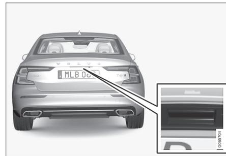
El pulsador de goma de la tapa del maletero puede utilizarse únicamente para desbloquear.
