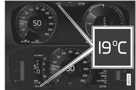
Ubicación del indicador de temperatura ambiente en las pantallas del conductor de 12" y 8". La imagen es esquemática. Los detalles pueden variar según el modelo de automóvil.
