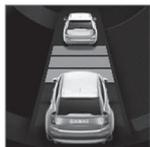
El conductor puede seleccionar diferentes intervalos de tiempo que se indican en la pantalla del conductor en forma de 1 a 5 rayas horizontales. Cuanto más rayas, mayor es el intervalo de tiempo.
