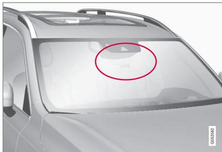
La zona señalada debe limpiarse con regularidad y no debe tener colocados adhesivos, objetos, películas antisolares, etc.
