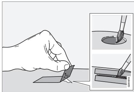
Si el daño no ha llegado al metal, puede aplicarse pintura para retoques directamente después de limpiar la superficie.
