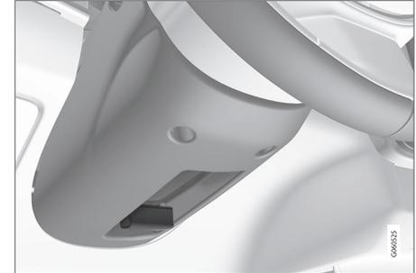
Palanca de regulación del volante.
