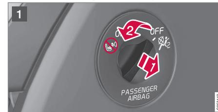
**1** Tire del interruptor hacia fuera y gírelo de la posición **OFF** a **ON**.
