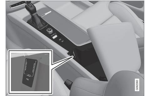
Puertos USB (tipo A) en la consola del túnel. Coloque el cable hacia delante para evitar que quede aprisionado al cerrar la tapa.
