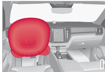
Airbag del volante y airbag de rodillas<sup>1</sup> en el lado del conductor del asiento delantero.
