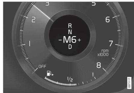
Visión general del patrón de cambios en la pantalla del conductor para la palanca de cambios pequeña.
