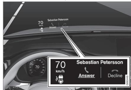
La pantalla de visualización frontal muestra advertencias e información referentes a la velocidad, las funciones del control de velocidad constante, la navegación, etc. en el campo visual del conductor. En la pantalla de visualización frontal se puede mostrar también información de señales de tráfico y llamadas telefónicas entrantes.
