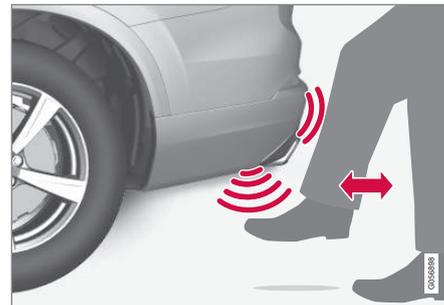
Movimiento con el pie en la zona de activación prevista del sensor.
