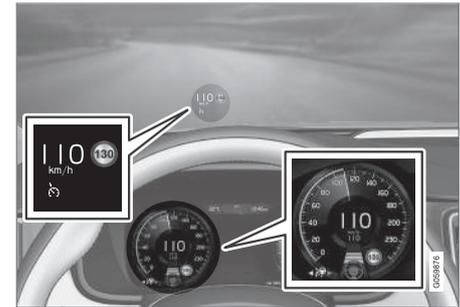
La imagen anterior muestra que se ha ajustado Pilot Assist para mantener una velocidad de 110 km/h (68 mph) y que no hay ningún vehículo delantero que seguir.
