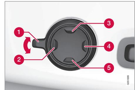
1. Active el control multifuncional girando el mando **1** hacia arriba o hacia abajo. La vista de ajustes del asiento se muestra en la pantalla central.
