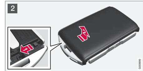
2 **1** Dé la vuelta a la llave, desplace el botón a un lado y deslice la carcasa de la parte trasera unos milímetros hacia arriba.
