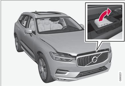
➔ Realice un barrido de izquierda a derecha en la abertura situada bajo el capó, desplace arriba y a la derecha el tirador para liberar el capó de su fijador de cierre y levante el capó.
