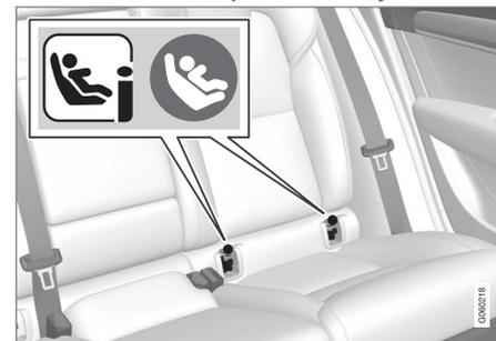
La ubicación de los puntos de fijación se indica con símbolos<sup>2</sup> en el tapizado del respaldo.
