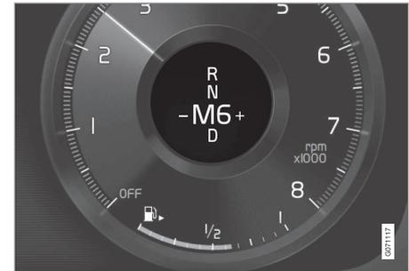
Indicador de cambio de marcha en pantalla del conductor de 12" con palanca de cambios pequeña\*.
