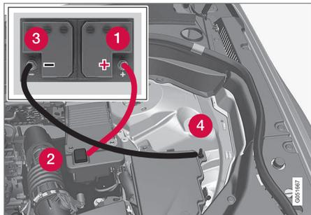
Puntos de fijación de los cables de arranque. El aspecto del compartimento del motor puede variar en función del modelo de automóvil y del nivel de equipamiento.
