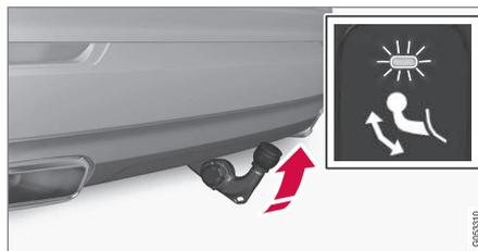
> El enganche de remolque se despliega sin quedar bloqueado. La luz de indicación destella con luz naranja. El enganche de remolque está listo para continuar hasta la posición bloqueada.
