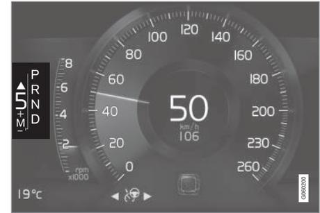
Indicador de cambio de marcha en pantalla del conductor de 8" con palanca de cambios grande.
