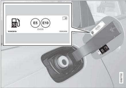
Seleccione el combustible homologado para su uso con el vehículo conforme al identificador<sup>14</sup> del interior de la portezuela del depósito. Consulte la información relativa a los combustibles homologados y el identificador en el apartado "Gasolina".
