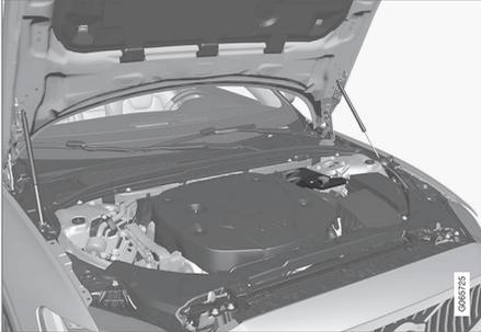
La batería de apoyo de 12 V está ubicada en el compartimento del motor.
