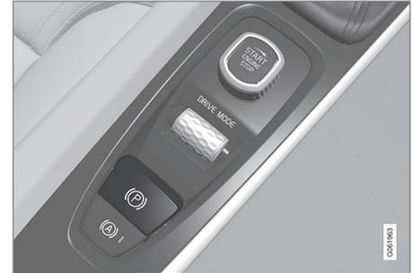
El control del freno de estacionamiento está situado en la consola del túnel entre los asientos.
