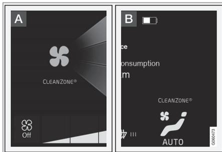
**A** El indicador se ve en la vista de climatización de la pantalla central.
