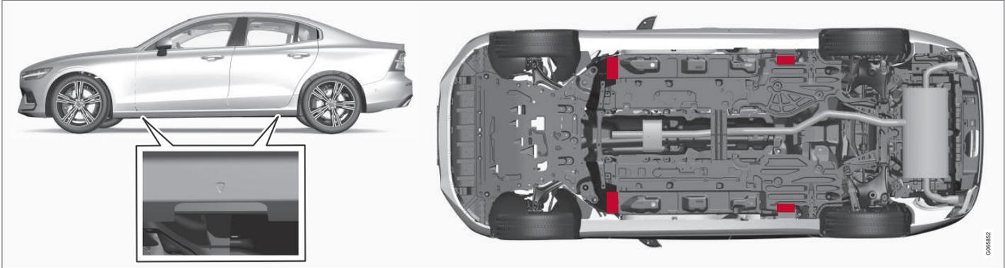
Los triángulos en la cubierta de plástico indican dónde están situados las fijaciones del gato o los puntos de elevación (de color rojo).
