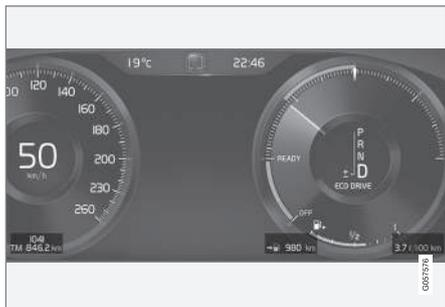
Ejemplo de información del ordenador de a bordo en la pantalla del conductor de 12". La imagen es esquemática. Los detalles pueden variar según el modelo de automóvil.
