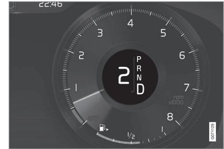
Pantalla del conductor al cambiar de marcha con las levas del volante, palanca de cambios grande.
