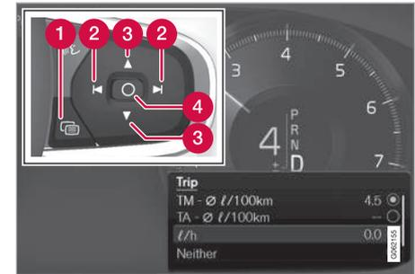
Abra y navegue en el menú de aplicaciones<sup>2</sup> con el teclado derecho del volante.
