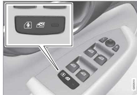
Botón de conexión y desconexión eléctrica.
