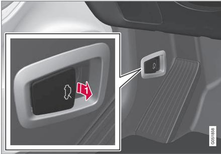
➔ Tire de la palanca junto a los pedales para soltar el capó de su posición de bloqueo.
