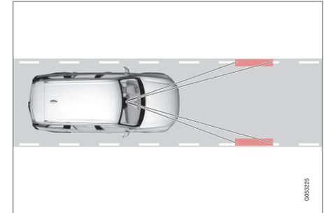
El sistema DAC lee el emplazamiento del automóvil dentro del carril.
