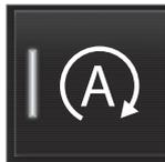
El sistema se desconecta con el botón **Encender/ Apagar** en la vista de funciones de la pantalla central. Cuando la función está desconectada, la indicación del botón está apagada.
