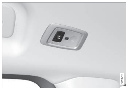
Los vehículos con techo panorámico* tienen dos unidades de luces, una a cada lado del techo. 10
