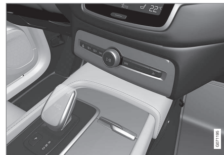
Visión general de la palanca de cambios pequeña, en la que no es posible desactivar el inhibidor del selector de marchas.
