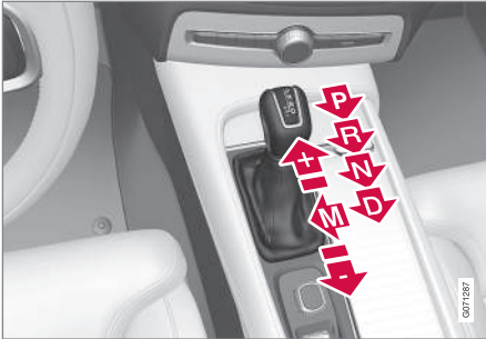
Vista general de la palanca de cambios grande y las posiciones de cambio.
