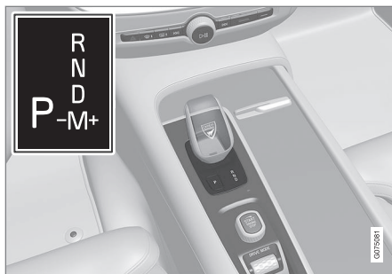
Visión general de palanca de cambios pequeña y patrón de cambios en la pantalla del conductor.
