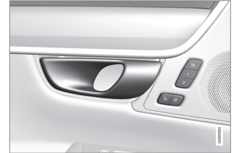
Manilla de apertura para desbloqueo alternativo de la puerta lateral 11 .
