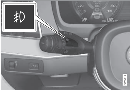
Botón para la luz antiniebla delantera.
