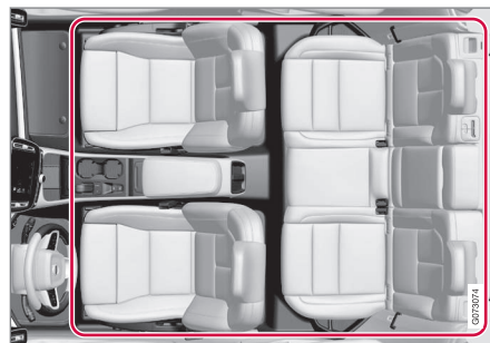
Zonas de climatización con climatización de 1 zona.
