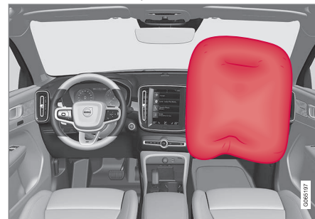
Airbag en el asiento delantero del acompañante.
