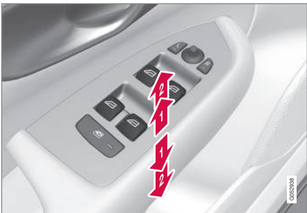
Accionamiento de los elevalunas eléctricos.
