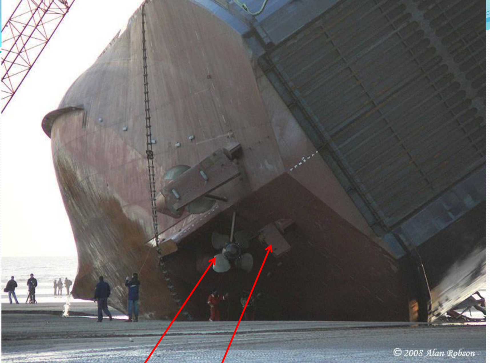
PROPELA Y TIMÓN DE ER DAÑADOS
