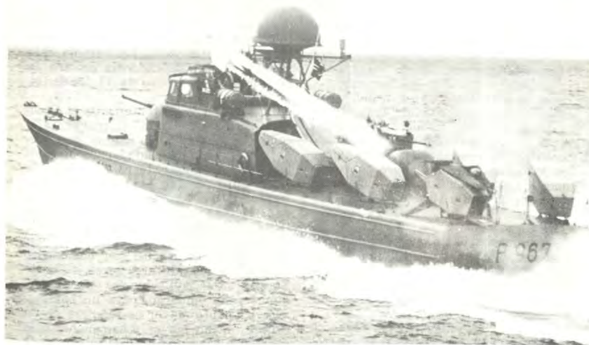
El misil "Penguin" es uno de los más pequeños disponibles actualmente, pese a ocupar todavía gran cantidad de espacio en cubierta. Seis lanzadores son vistos en esta LRA noruega clase Storm.
