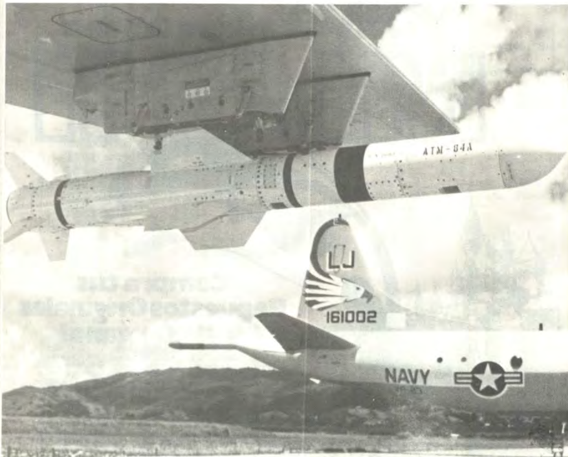
La versión aire-superficie es utilizable tanto por aviones de combate como de patrulla y reconocimiento aéreo. Un misil ATM-84A colgado del ala de un avión "Orion" de la US Navy.
