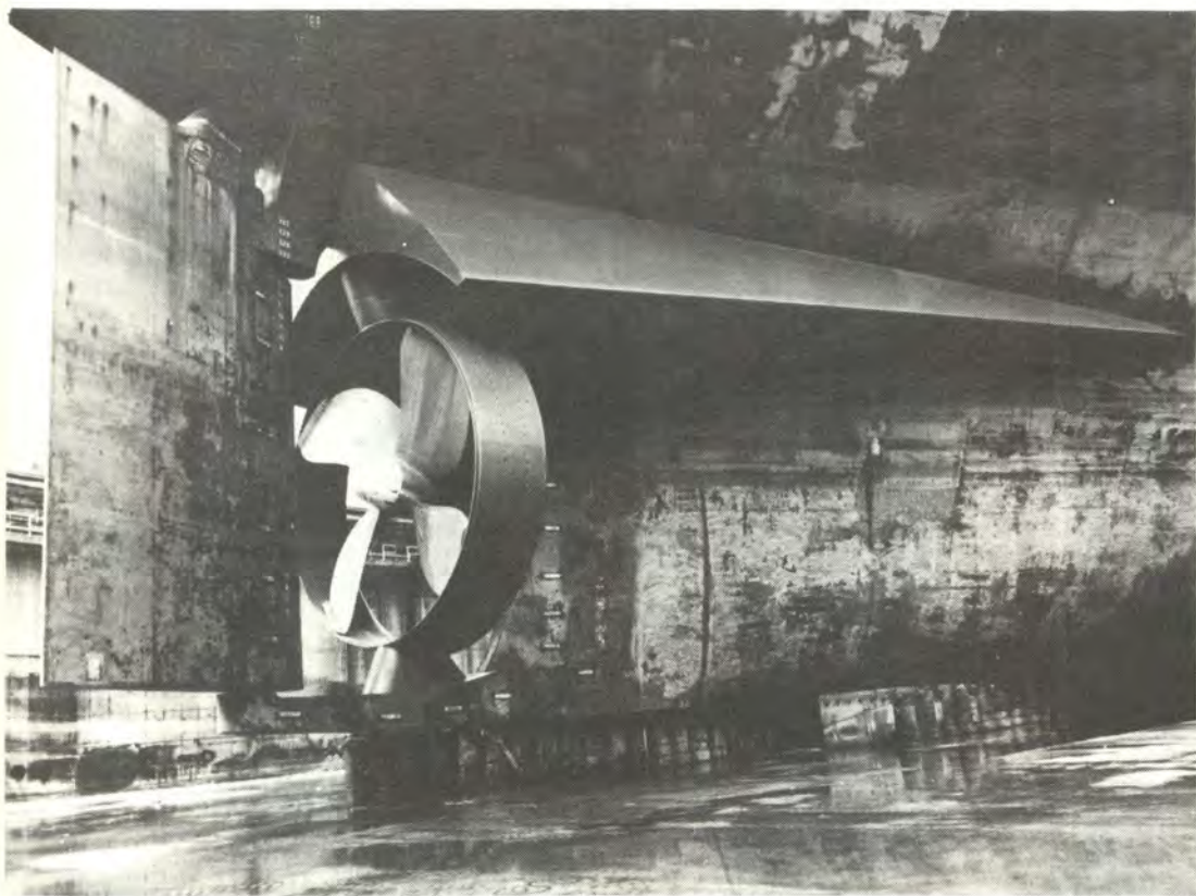
La nueva hélice de buque TVF (Tip Vortex Free) desarrollada por Astilleros Españoles S. A. (AES A), la misma que reduce el consumo de combustible en un 15 por ciento.
