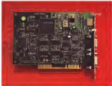
Grazie a TVCoder è possibile convertire l'uscita VGA del computer in un segnale standard PAL o NTSC per videoregistrazione che separato fornisce anch'immagine.
