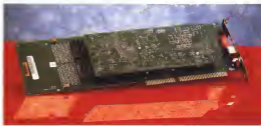
Primo piano sulla scheda. Da notare le tre connessioni ai terminali di cui il crocicchio di ancoraggio la presenza delle connessioni d'input, compatibili a S-Video, per la fila degli switch di settaggio.
