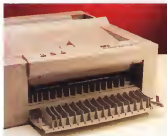
Rotolando il frontale è possibile nascondere il contenuto delle pagine stampate. L'entrata della stampante presenta solo il connettore di alimentazione e quello di interfaccia.
