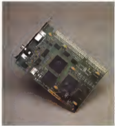
L'ottima realizzazione hardware della Captivator si può notare in questo primo piano: i tre chip fondamentali sono uno «scaling processor», un «video processor» ed uno di gestione sincronismi.
