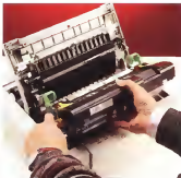
Ritornando il vassoio di uscita di documento si accede al vassoio per il posizionamento della cartuccia toner
