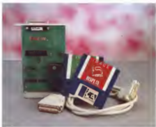
La scheda d'interfaccia, i due dischetti e il cavo di collegamento (che si inserisce a quello usato nelle scansioni parallele, noi con una diversa configurazione dei pin).
