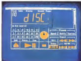
Il pacchetto di controllo di Jukebox che pilota un CD collegato allo SCSI adapter.
