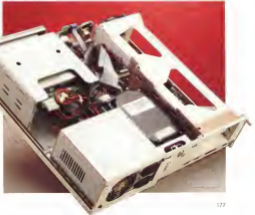
Due viste generali della macchina aperta, che mettono in luce la distribuzione modulare ed ordinata dell'hardware: Da notare la posizione possessoria dell'hard disk ed il possesso delle schede di espansione esterne.
