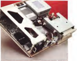
Due viste generali della macchina aperta, che mettono in luce la distribuzione modulare ed ordinata dell'hardware: Da notare la posizione possessoria dell'hard disk ed il possesso delle schede di espansione esterne.
