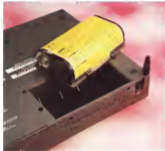
La batteria ricaricabile è scivola sul fondo della macchina
