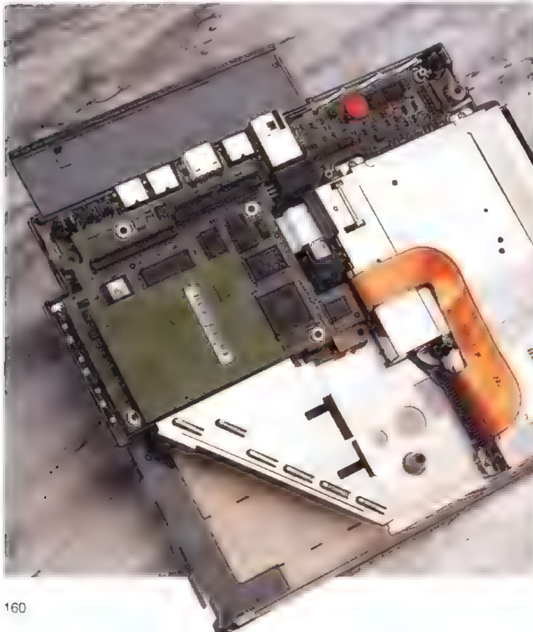
◀ La macchina appena aperta: tutta l'elettronica è posta su tre schede sovrapposte
