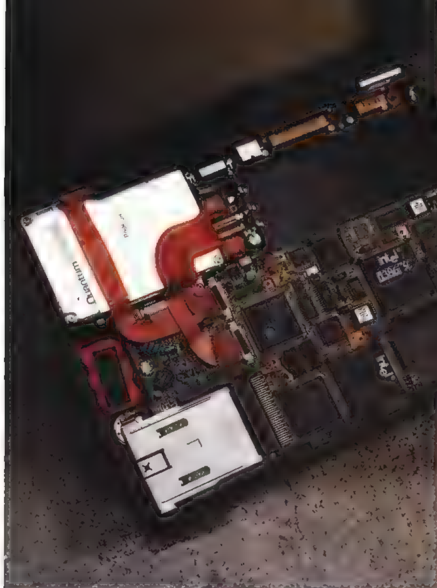
La macchina appena aperta (l'hard disk è in alto a sinistra, in basso a sinistra è visibile l'alloggiamento per schede PCMCIA, a destra lo spazio (raggiungibile dal fondo) per le espansioni di memoria e il coprocessore matematico, in alto a destra l'alloggiamento per la batteria ricaricabile)
