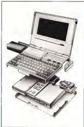
Versione «zippata» del nuovo portatile Compaq: in alto il piccolo monitor estraibile e a destra è la batteria NiCd a sinistra. Tutta l'elettronica delle macchine è deposita su l'hard disk e la meccanica per microloggy da 1-44 mega.
