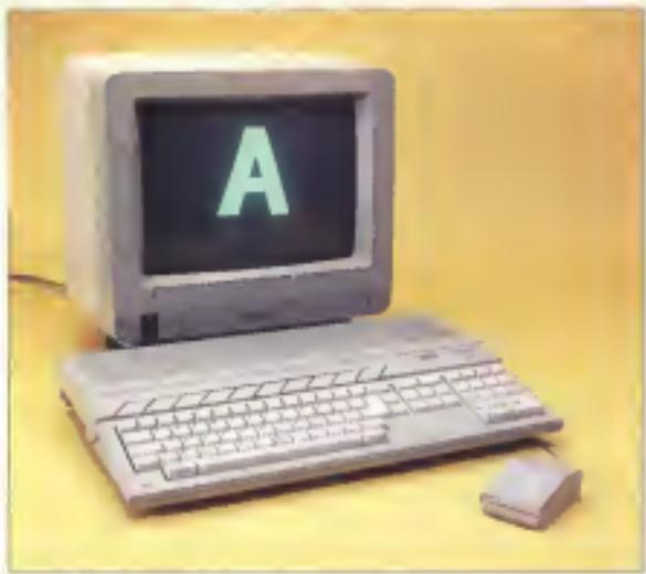
**L'**Atari 1040, così come viene scartato dalla sua confezione, dispone internamente di ben un megabyte di memoria (delle tre macchine in prova, in tal senso, la più fessita) e di un drive da 720 k formattato.
