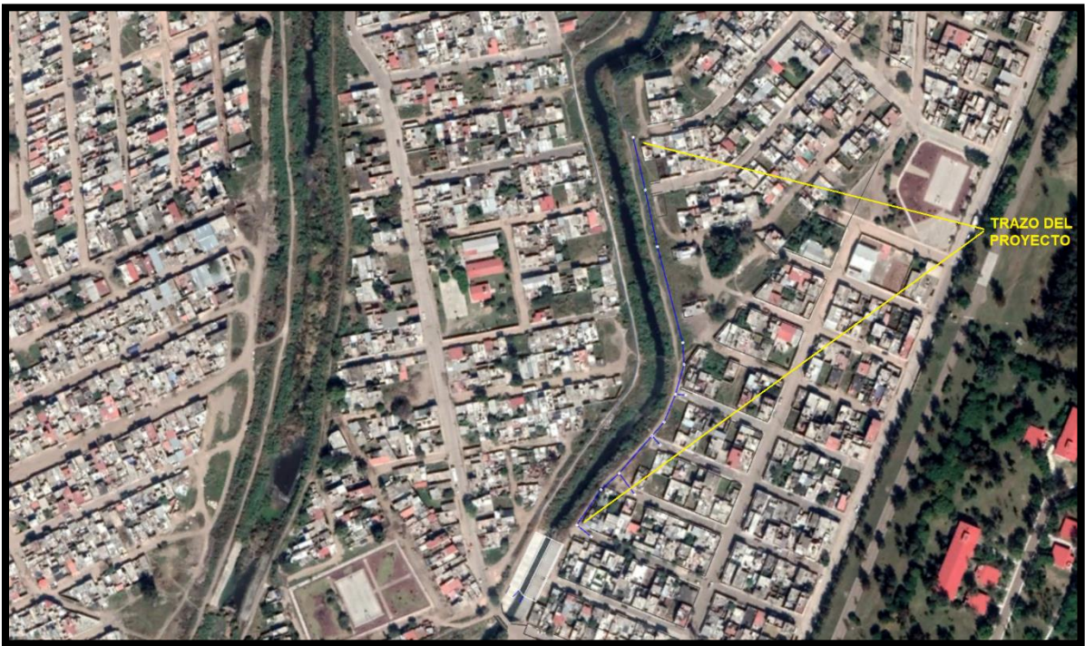
Imagen ilustrativa del trazo de la tubería con incidencia en zona federal en el paso en los márgenes del arroyo (líneas azules). El trazo será subterráneo con excavación, sin implicar retiro de vegetación de importancia. (En capítulo VIII se presenta evidencia fotográfica del trazo)
