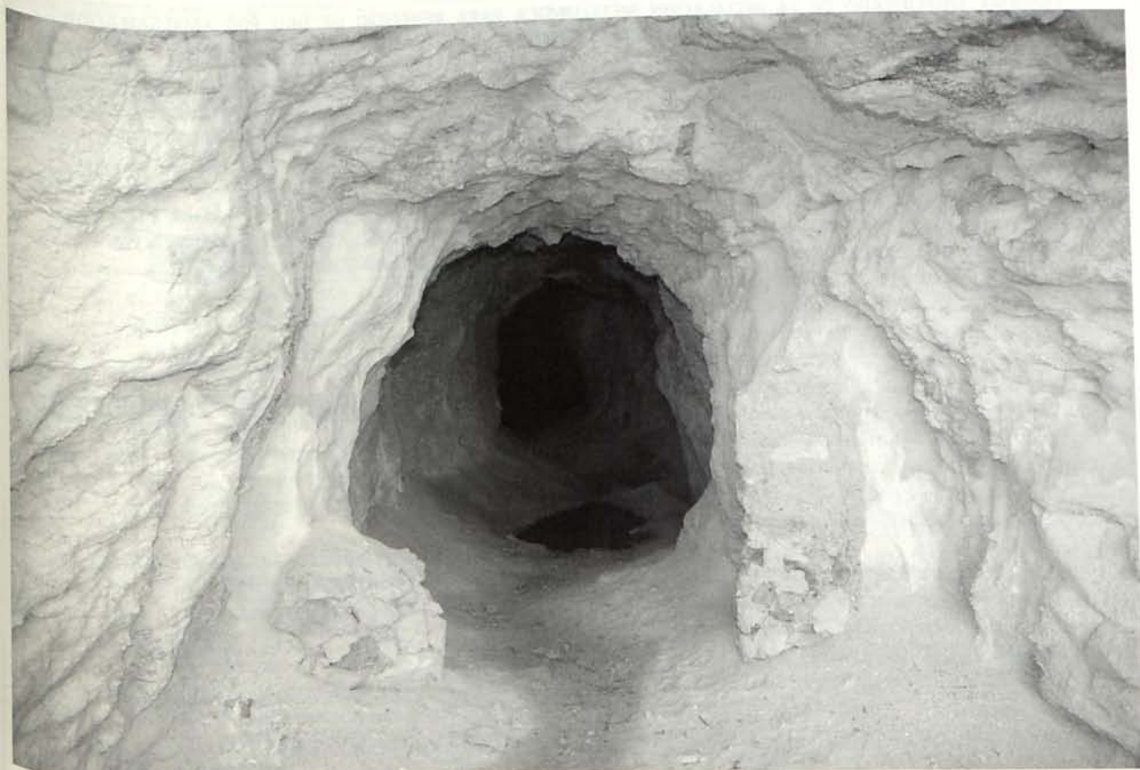
Figura 3. Interior de una de las galerías de la mina "Blanca y Negra". En las paredes se puede intuir el elevado grado de alteración hidrotermal de las rocas.
