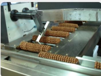
Otro de los dispositivos de esta enpaquetadora es el sistema de traspaso. Este esta comandado por dos servomotores que interpolan la curva de entrada de producto, garantizando así un excelente resultado en el cuidado del producto.
