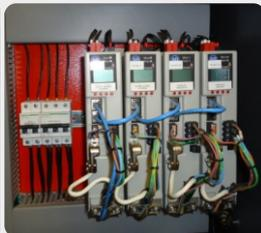
El tablero eléctrico de la máquina es de última generación y posee un sistema de control multieje para comandar los 7 servomotores que tiene la máquina.
