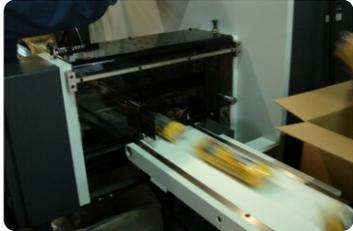
**NO PAQUETE NO PRODUCTO:** La máquina contiene un sistema que no realiza el paquete si no viene producto por la cadena de alimentación reduciendo notablemente el scrap por paquete vacío.
