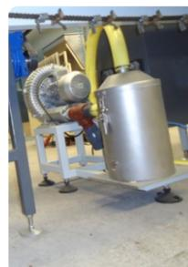
La máquina trae un sistema de aspiración de aire, dicho sistema asegura la estabilidad del paquete durante el paso por el acompañador lateral y ciñe el producto al envoltorio logrando así una mejor terminación del mismo
