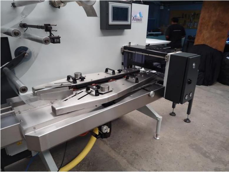
La empaquetadora W2 es una máquina automática continua del tipo de carga horizontal
