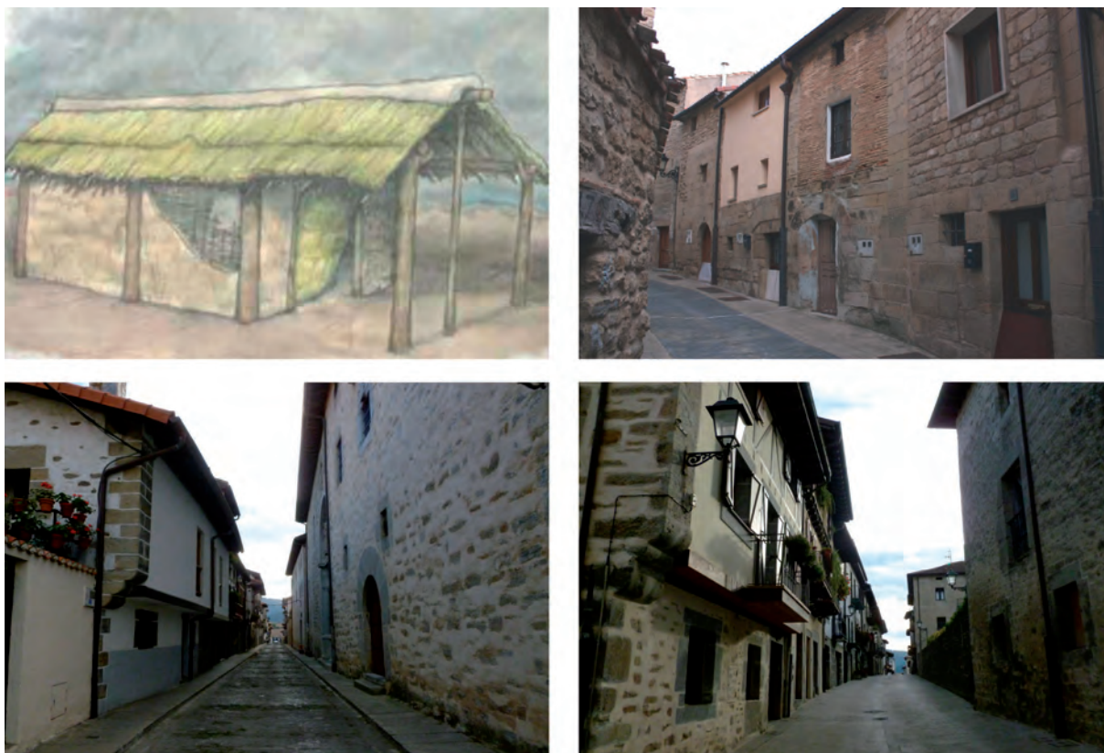
Figura 132; Arriba a la izquierda recreación de una cabaña altomedieval de Vitoria-Gasteiz a partir de las excavaciones arqueológicas realizadas en el entorno de la catedral vieja en 2001. A su lado, caserío apretado de Labraza (calle San Roque) con muros medianiles compartidos entre solares. En la fila inferior, los aleros salientes en Artziniega aseguraban el resguardo de la acera y la evacuación de las goteras hacia las calles y callejas, lejos de los cimientos, aunque los canalones contemporáneos recogen y dirigen hoy día las aguas. La propia disposición del tejado (las vertientes) es importante en estas cuestiones. Fuentes: Azkarate Garai-Olaun, A., «Catedral de Santa María (Vitoria-Gasteiz)», Arkeoikuska 2001, Gobierno Vasco, Vitoria-Gasteiz, 2002, 179-187, p. 180 para la primera imagen y elaboración propia en el resto.
