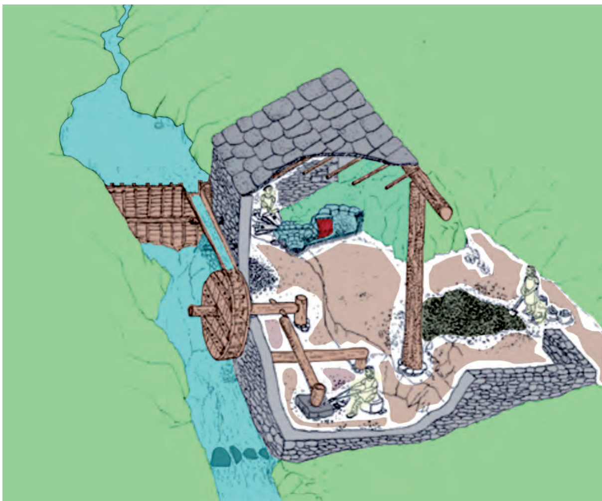
Figura 218; Reconstrucción ideal de la farga de Fabregada (Sant Esteve de la Sarga), según Ferran Compte y Marta Sancho. Se trata de un tosco taller datado hacia el siglo XII, a medio camino entre las haizeolak de monte y las potentes ferrerías hidráulicas del siglo XVIII. Existe energía motriz para impulsar el martinete pero el horno de reducción todavía se alimenta de forma manual. Fuente: elaboración propia sobre dibujo original en blanco y negro tomado de Sancho, M., «El hierro en la Edad Media: Desarrollo social y tecnología productiva», Anuario de Estudios Medievales , 41-2, 645-671, 2011, p. 668.
