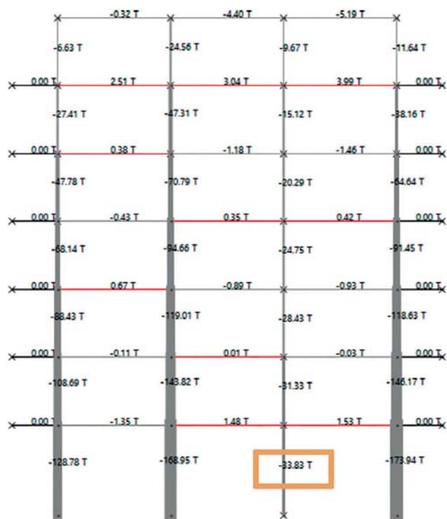
Figura 3b. Axials produïts en el pòrtic amb \delta = 20 mm.
