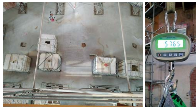
Figura 12. Comprobación del peso de los depósitos vacíos.
