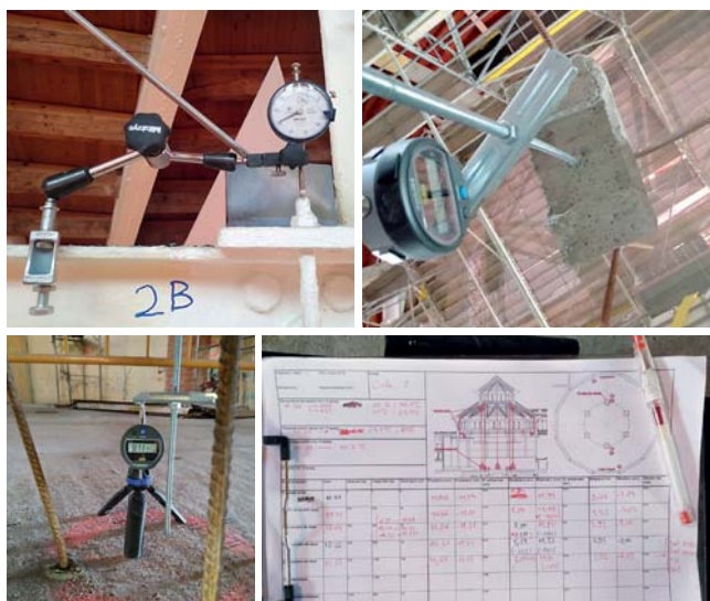
Figura 14. Relojes comparadores para mediciones de deformaciones en las pruebas.
