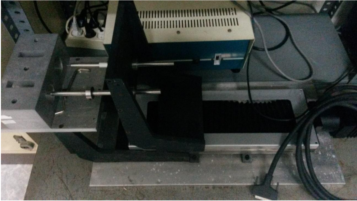
Figura 2.3 Imagen del sistema de inyección (motor MT-160-250 de Newport), donde puede observarse el soporte para las jeringas. En el caso de mezclas binarias con el ITC, sólo se utilizará una jeringa.
