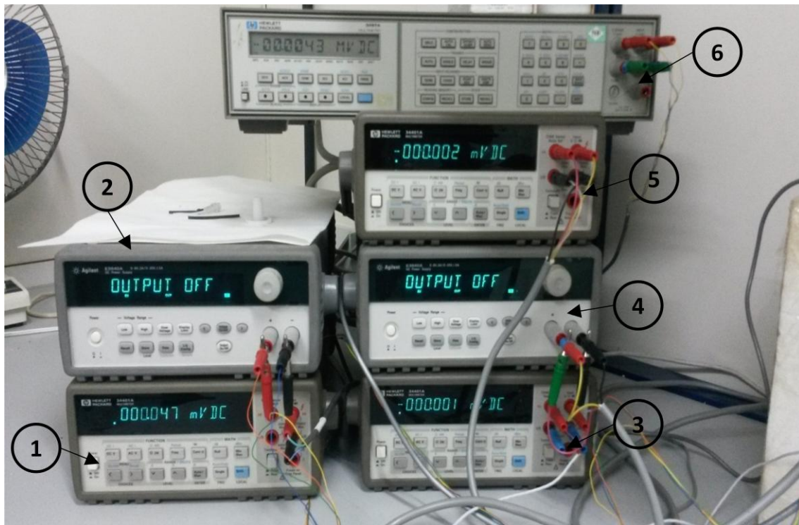
Figura 2.21 Dispositivos de control utilizados en el FM donde: (1) Multímetro HP34401A para la lectura de la señal calorimétrica, (2) Multímetro HP3478A + fuente de alimentación E3640A para la medida y modulación de la potencia de la resistencia de calibración, (3) Multímetro HP34401A para la medida de la temperatura de la célula de mezcla, (4) Multímetro HP34401A + fuente de tensión DC HP6633A para la medida y modulación de la resistencia del control de temperatura, (5) Multímetro HP34401A para la medida de la temperatura del termostato (bloque calorimétrico) y (6) Multímetro HP para la lectura de la temperatura de la cámara en las inmediaciones del calorímetro.
