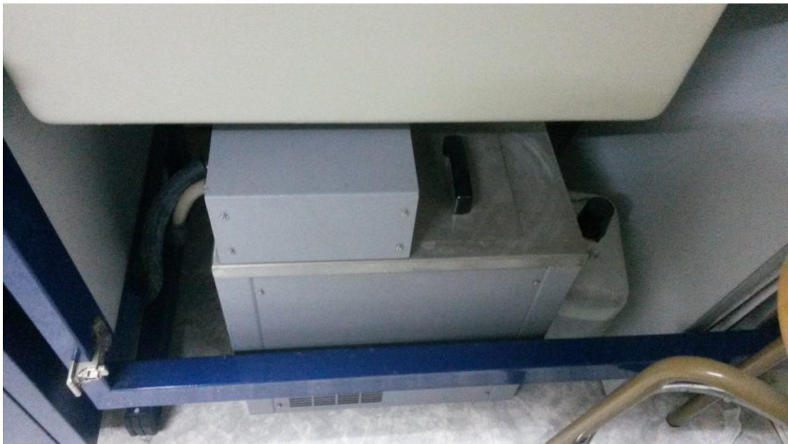
Figura 2.2 Imagen del baño termostático auxiliar Grant LTD 6 (de -20 a 100 °C) que hace de foco frío (22 °C) para la disipación de calor del baño termostático principal TAM2277.
