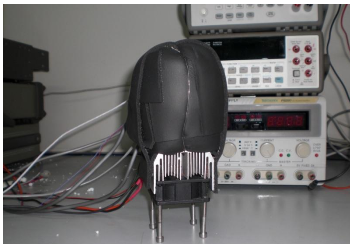
Figura 2.20 Bloque calorimétrico con el aislamiento de Armaflex®.
