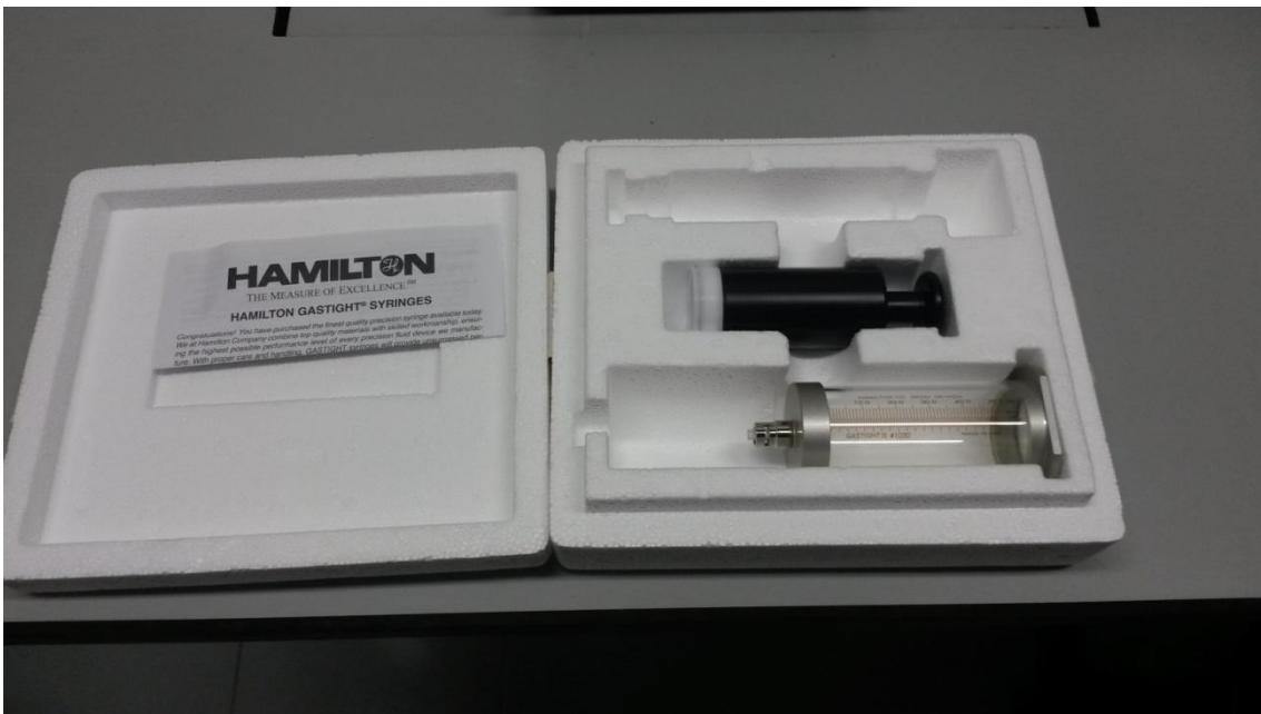
Figura 2.4 Imagen de la jeringa Hamilton de 50 mL destinada a la inyección del líquido sobre el que ya se encuentra en la célula de mezcla.
