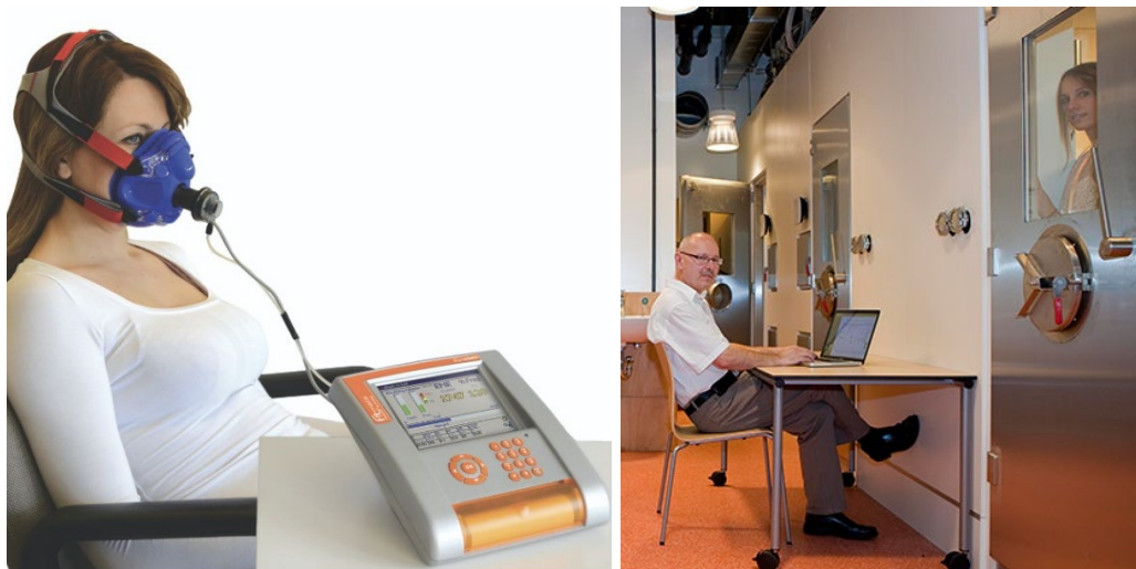
Figura 2.4. Dispositivos de calorimetría indirecta. Izquierda: calorímetro indirecto de circuito abierto [68], derecha: calorímetro indirecto tipo habitación [69].
