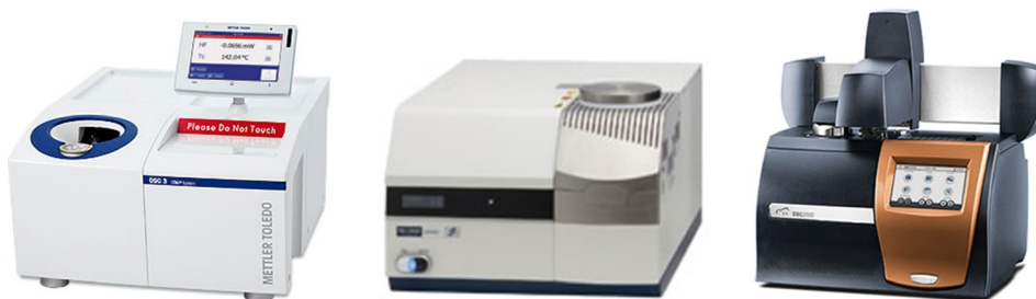
Figura 2.2. Imágenes de dispositivos DSC. De izquierda a derecha, DSC – 3 (Mettler Toledo) [33], DSC7000 (Hitachi) [34], DSC2500 (TA instruments) [35].
