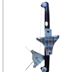
VWN4-B680AEQL VWN4-B680AEQR PASSAT B5 '99-05 FR WINDOW REGULATOR W/O PANEL 3B1 837 461 FL 3B1 837 462 FR
