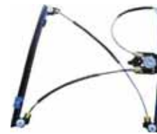
RN61-B680EQL RN61-B680EQR ESPACE '03-12 FR WINDOW REGULATOR W/O MOTOR 8200 017 903 FL 8200 017 893 FL 8200 017 904 FR 8200 017 894 FR
