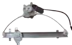
NSQ2-B680EL NSQ2-B680ER CEFIRO&A32 '95-99 FR WINDOW REGULATOR W/MOTOR 80701/0-40U00 FL/FR 80701/0-40U10 FL/FR
