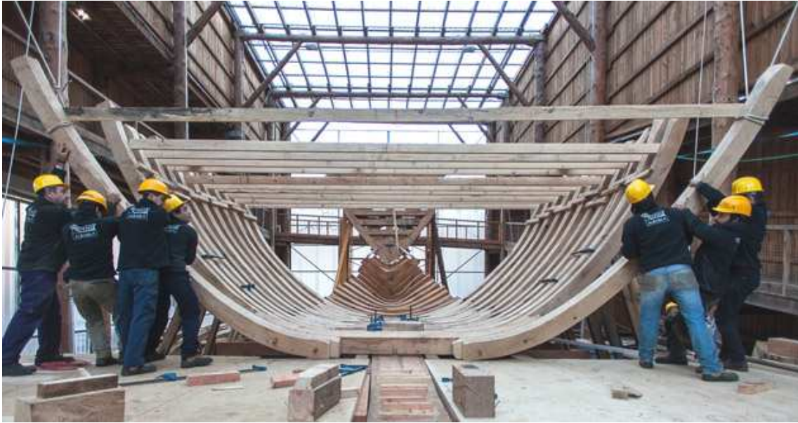
図 58： サン・ファン号のレプリカのフィエールの据付
