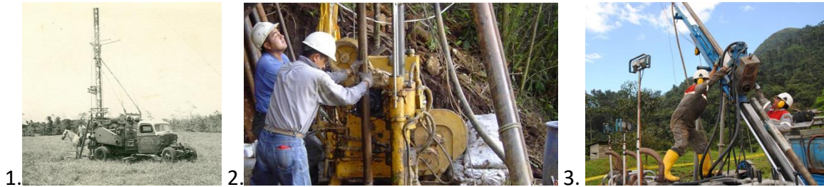
1. Máquina perforadora montada sobre camión, 1950, 2. Perforadora a diamantina Long Year 48, Higgeco perforaciones, 1980s, 3. Perforadora Hidrocore de gran alcance, Hubbard perforaciones, 2014.
