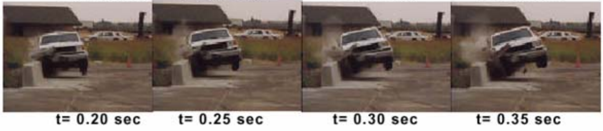
Ensayo camioneta 2000kg, 100km/h a 25°
