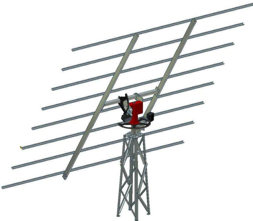
11- Se colocan las barras en forma de "U", como se especifica más adelante. Si se pone el seguidor en posición horizontal alimentando el motor con 12 V, se puede facilitar la tarea.
