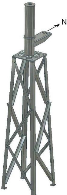
3- Se coloca la parte fija en dirección al norte, tal como muestra la imagen (tornillos M20 y tuercas). Los 6 tornillos se tienen entornillar con 590 Nm. Localizando una referencia lejana con un mapa topográfico o con una fotografía por satélite bien orientada, se puede determinar el norte con mucha más precisión que con una brújula.
