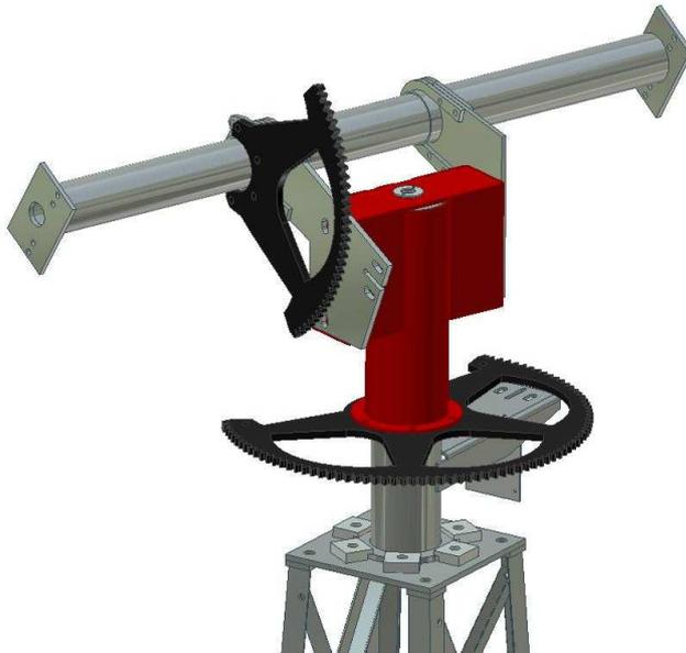
8- Se coloca la porción de corona dentada con cuatro tornillos M14 y sus tuercas. Los tornillos M14 se han de atornillar con un par de 200 Nm. Para paneles planos y para la mayoría de paneles de concentración, el volant se tiene que fijar con los 4 agujeros indicados con la letra (b) en la imagen anterior.
