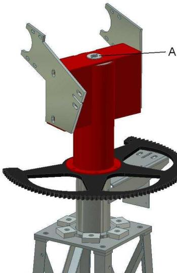
6- Se introduce la parte móvil, se fija el volante con cinco tornillos M16 y sus tuercas. Se pone la arandela (A), (tornillos M6) para que no pueda salir el conjunto, y las dos piezas laterales con tuercas M20. Los 5 tornillos M14 se tienen que enroscar con 200 Nm.
