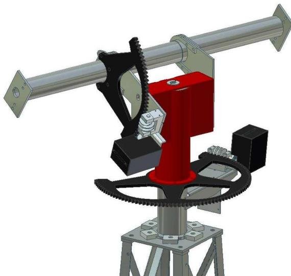
9- Se colocan los motores y sus cajas protectoras. Los tornillos M14 se han de atornillar con un momento de 200Nm. La caja de la electrónica va colocada, preferiblemente en un lugar de la columna a la altura de la vista.
