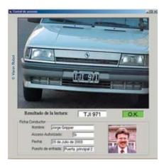
El sistema de lectura de patentes permite controlar vehículos en plena vía pública a una velocidad de hasta 170 km./h
