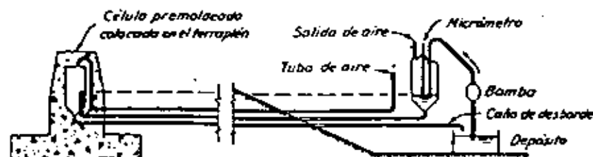
Fig. 66.6. Nivel de agua para medir el asentamiento de un punto en el interior de una presa (según Mallet y Pacquant, 1951).
